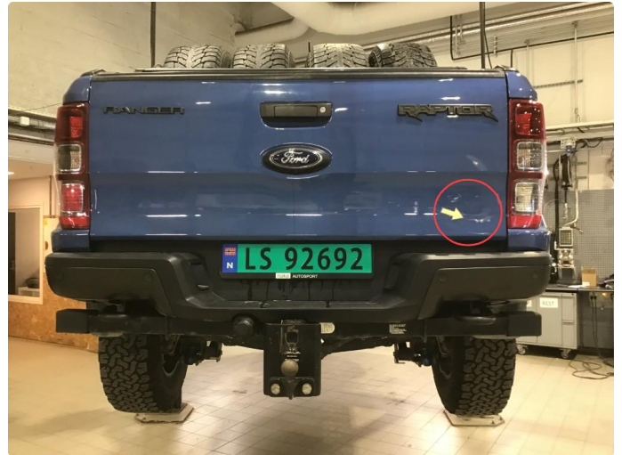
1.2 Liten p-bulk nedre del bakluke h-side , normal bruksslitasje .
