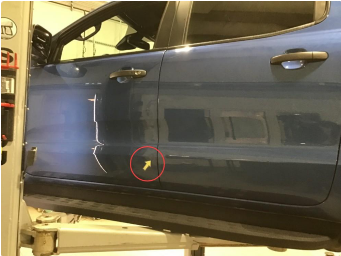
1.1 Liten p-bulk nedre bakre del v- framdør , normal bruksslitasje .
