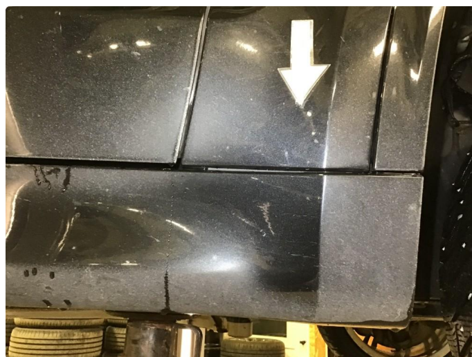
1.2 Noe lakkslittasje på dører, poleres. Normal slittasje ihht. alder og kjørelengde.
