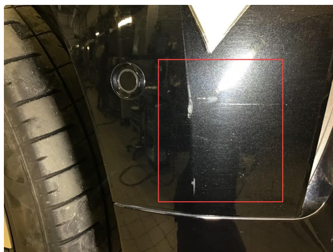
1.4 Noe riper / sår h-side frontfanger , normal bruksslitasje .
