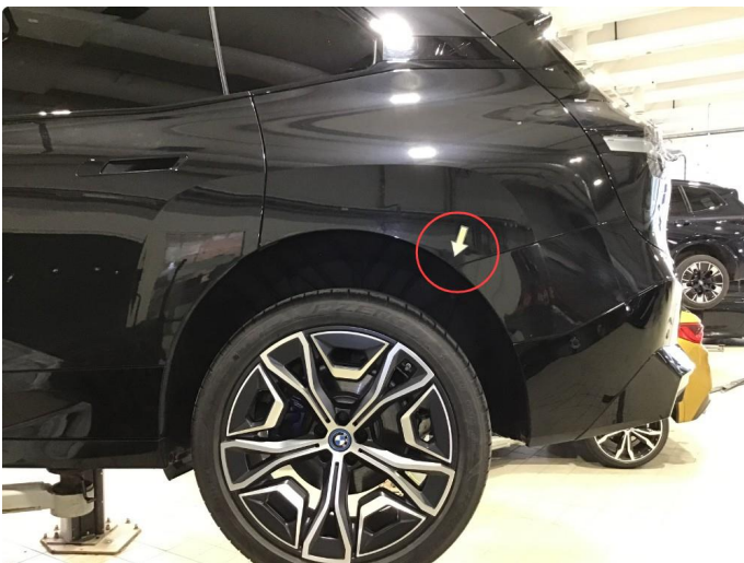
1.1 Steinsprut hjulbue / baksjerm v-bak , normal bruksslitasje.
