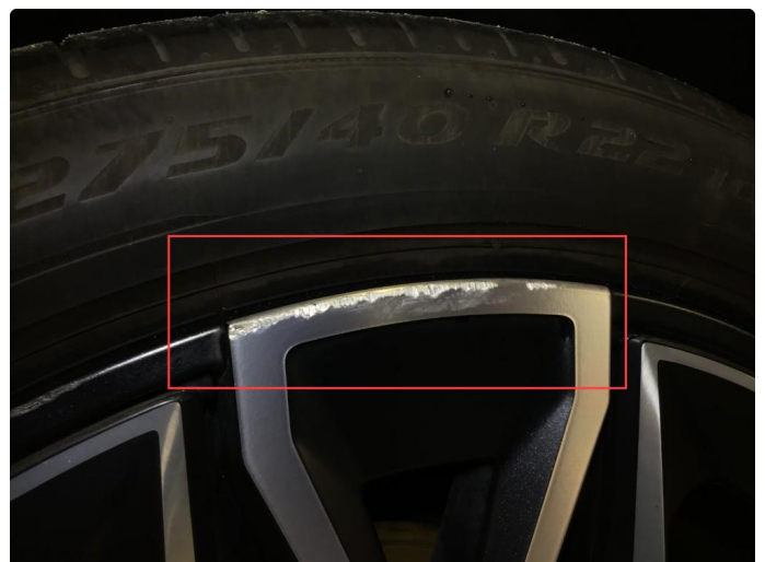
1.2 Noe sår sommerfelg h-ram + h-bak , normal bruksslitasje.
