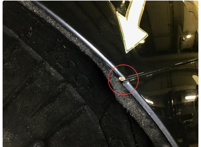
1.1 Steinsprut hjulbue / baksjerm v-bak , normal bruksslitasje.
