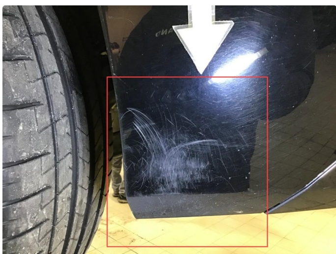
1.6 Noe riper bakfanger , normal bruksslitasje .
