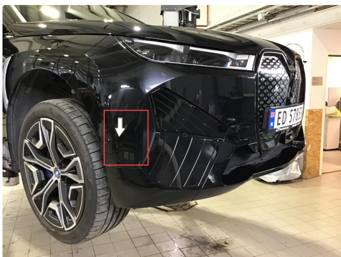
1.4 Noe riper / sår h-side frontfanger , normal bruksslitasje .
