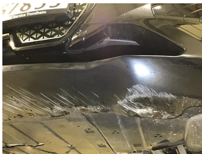
1.5 Noe skrubbermerker underside frontfanger , normal bruksslitasje .
