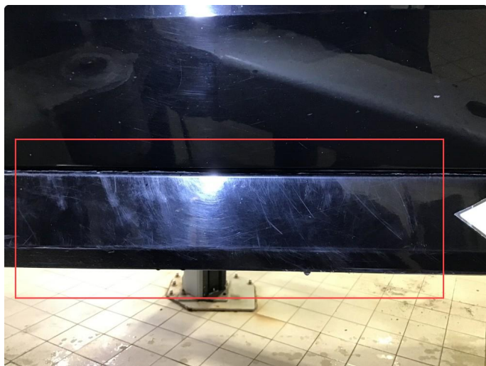
1.7 Noe riper kanalskjørt h+v side , normal bruksslitasje .
