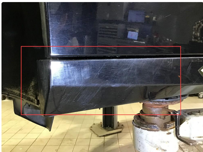
1.7 Noe riper kanalskjørt h+v side , normal bruksslitasje .
