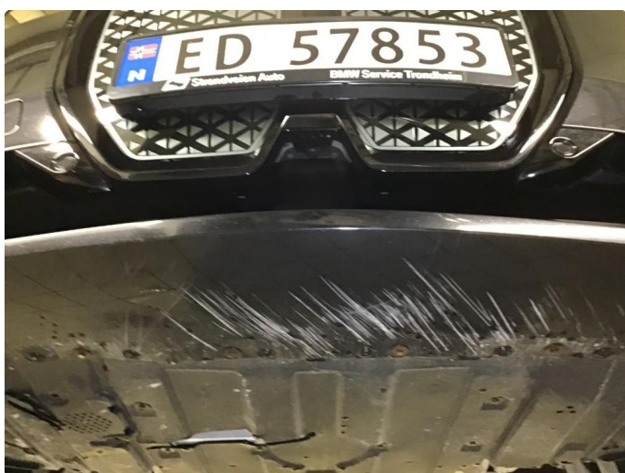
1.5 Noe skrubbermerker underside frontfanger , normal bruksslitasje .
