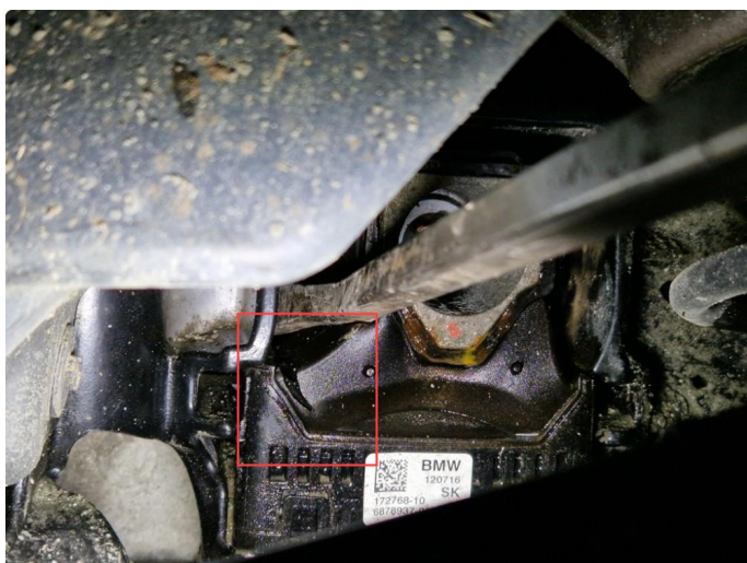
3.1 Defekt motorfeste v-bak , sluppet i vulking.
