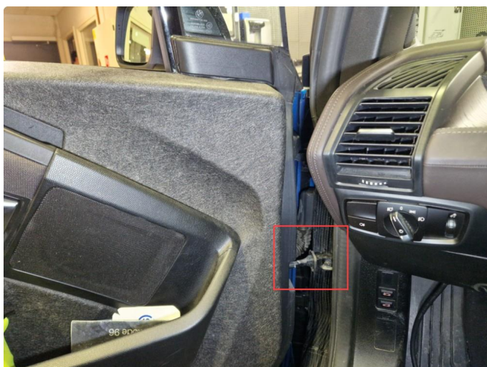
2.1 Hengsler defekt/slitt. Defekt dørstopper v- fram , veldig treg.
