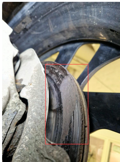
5.1 Rust bremseskiver fram , flak av bremseskive har løsnet . Bremseklosser målt til 4mm.
