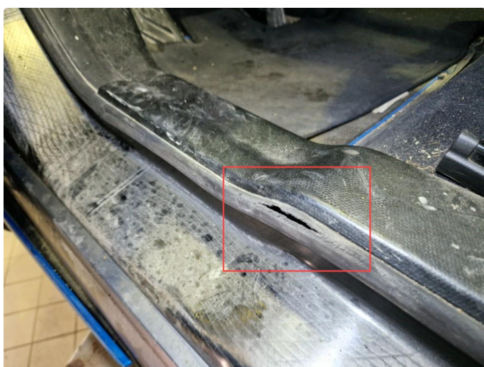
2.6 Skadet dørkarmlist v-side.
