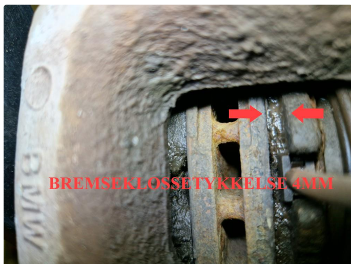
5.1 Rust bremseskiver fram , flak av bremseskive har løsnet . Bremseklosser målt til 4mm.
