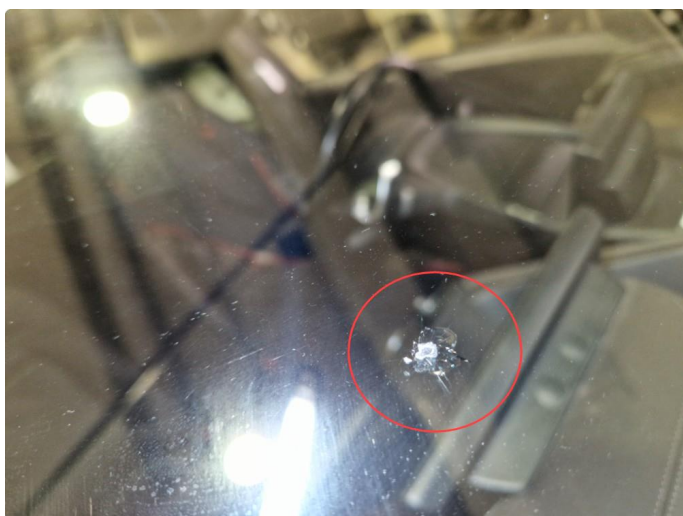
2.8 Steinsprut frontrute , er reparert tidligere.
