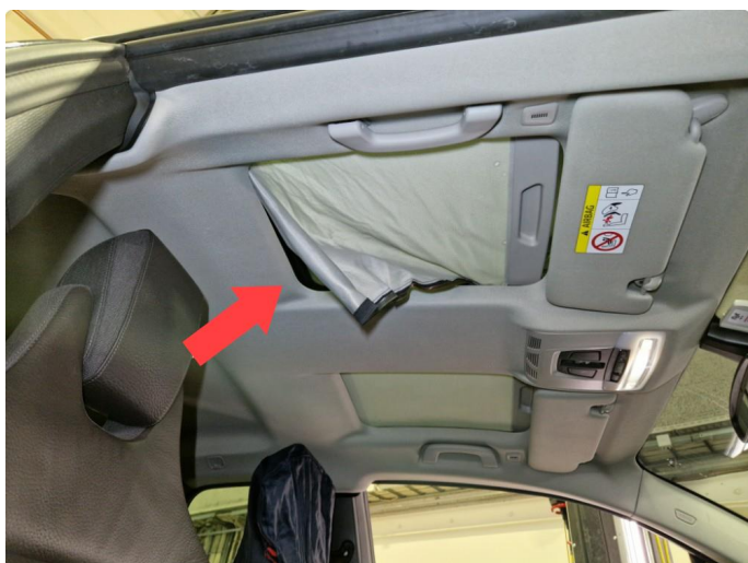
6.2 Skadet takluketrek h-side.
