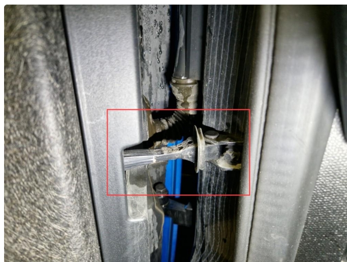
2.1 Hengsler defekt/slitt. Defekt dørstopper v- fram , veldig treg.
