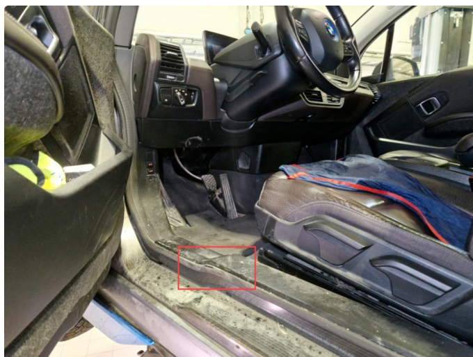
2.6 Skadet dørkarmlist v-side.
