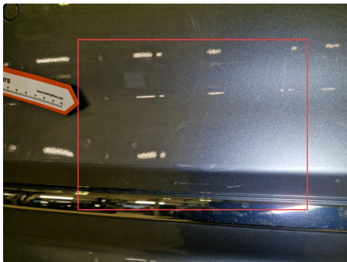
1.5 Noe riper og merker på bakfanger.
