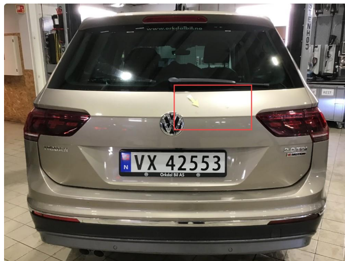
1.3 Noe sår øvre del bakluke , er flekket tidligere.
