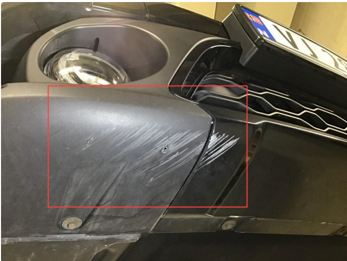
1.2 Noe skrubbermerker underkant fremfanger, regnes som normal bruksslitasj.
