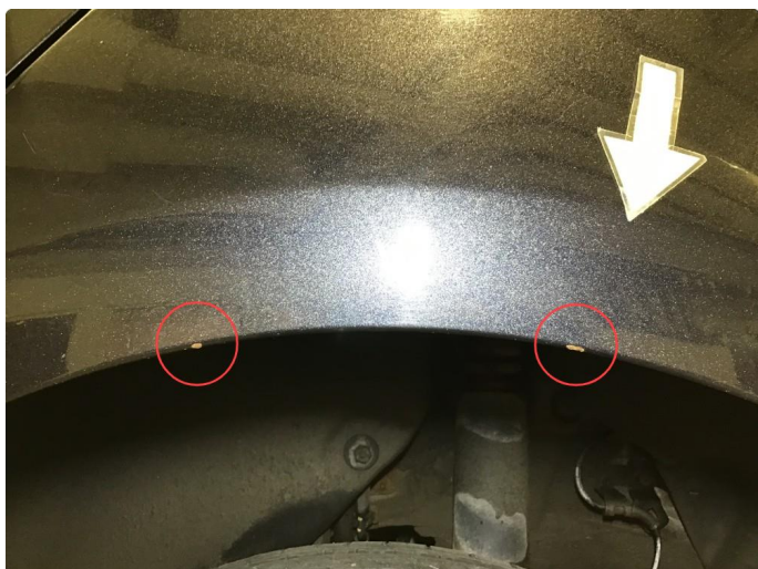
1.3 2 Stk steinsprut hjulbue vbak og 1 stk steinsprut hjulbue h-bak.
