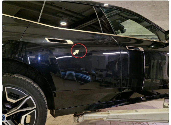
1.2 Liten p-bulk høyre bakdør, normal bruksslitajse.
