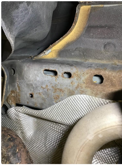
2.1 Rust underside ved bakstilling.
