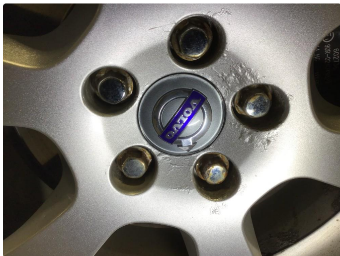
2.11 Korrosjon alle vinterfelger.
