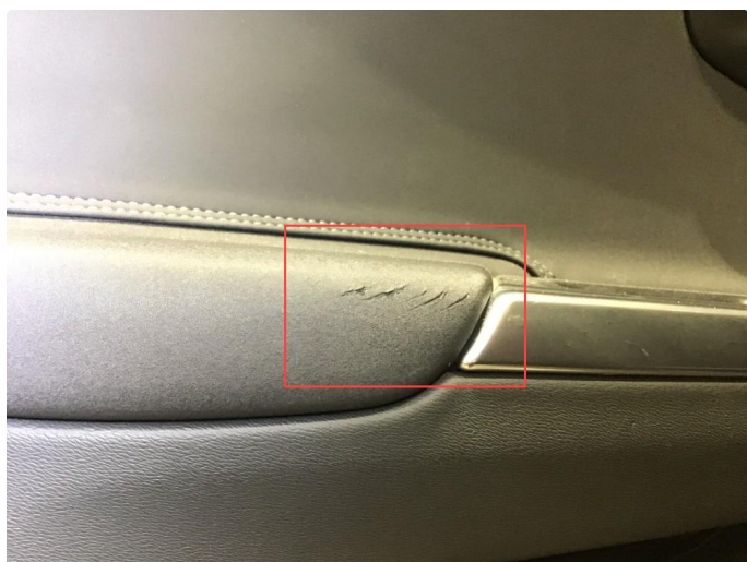
4.1 Skadet dørtrekk v-bak.
