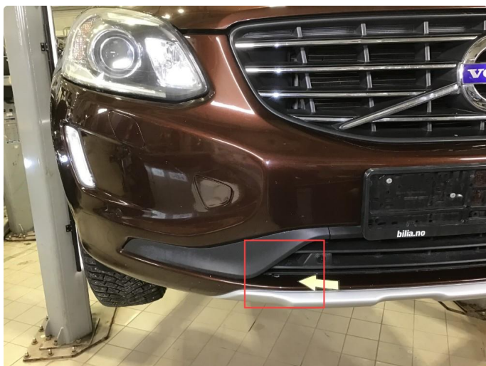
2.14 Noe lakksår / skade nedre del midtre h-side frontfanger.
