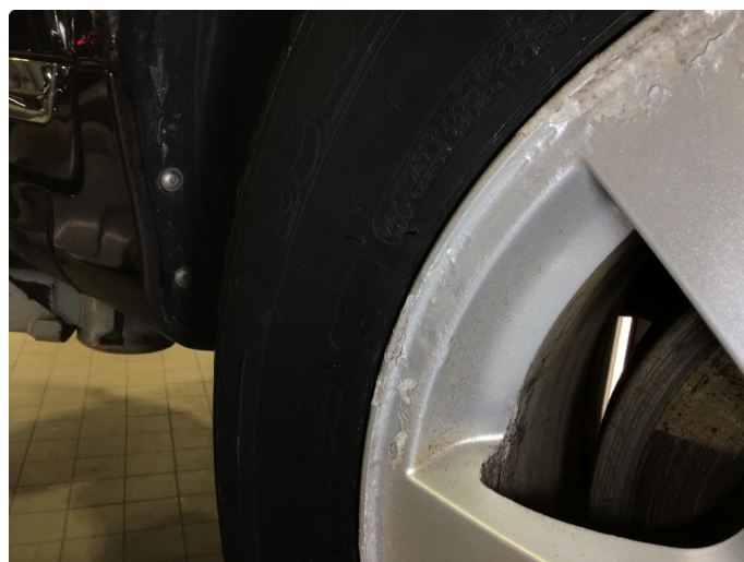
2.11 Korrosjon alle vinterfelger.
