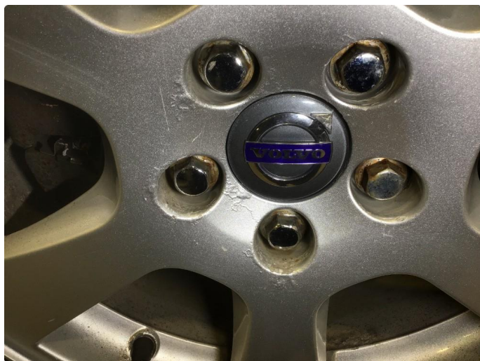
2.11 Korrosjon alle vinterfelger.
