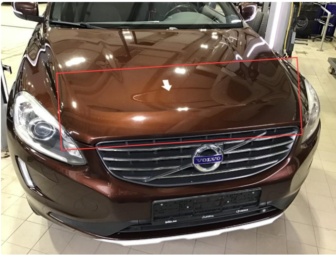
2.2 Mye steinsprut fremre del panser.
