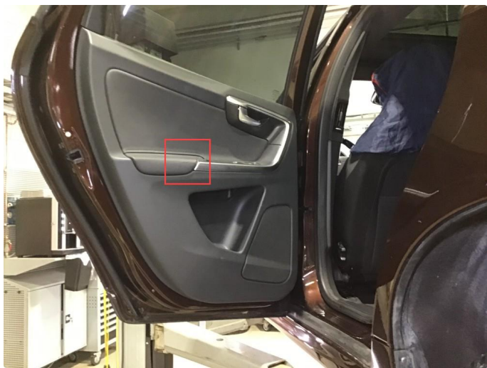
4.1 Skadet dørtrekk v-bak.
