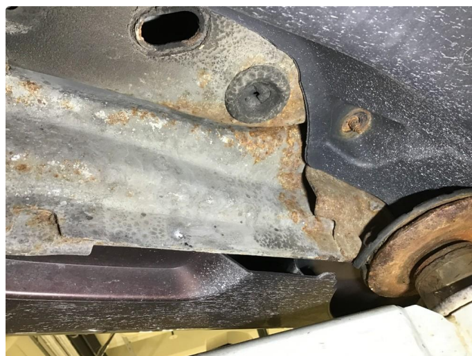
2.1 Rust underside ved bakstilling.
