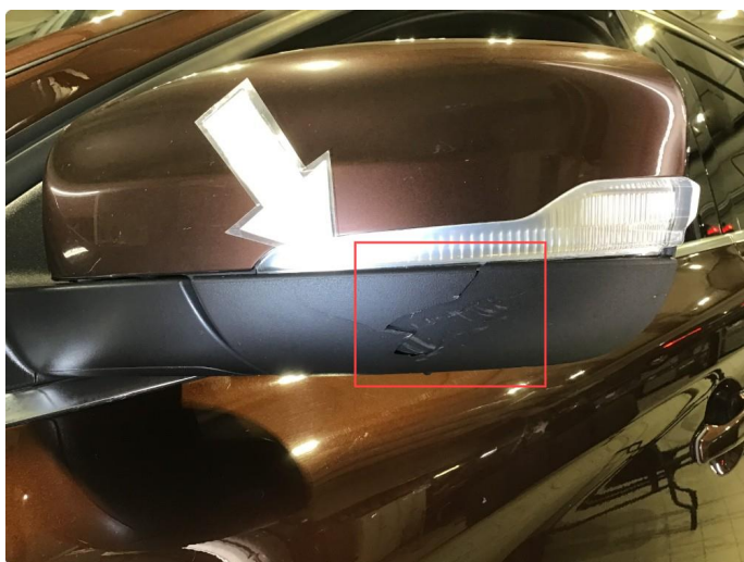
2.8 Skadet underdel speilhus vside.
