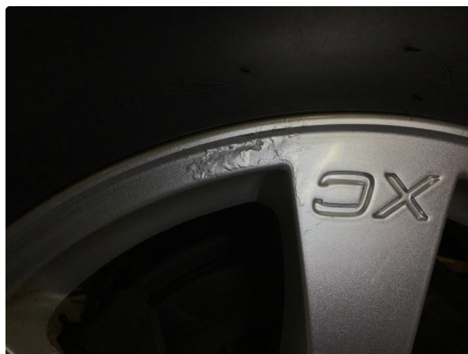
2.11 Korrosjon alle vinterfelger.
