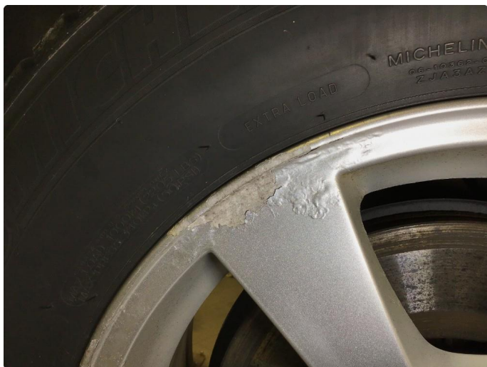
2.11 Korrosjon alle vinterfelger.
