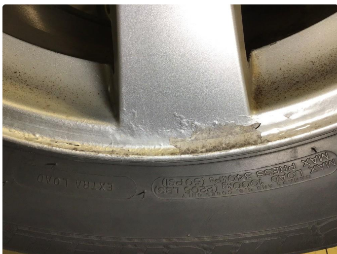
2.11 Korrosjon alle vinterfelger.
