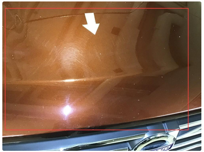
2.2 Mye steinsprut fremre del panser.
