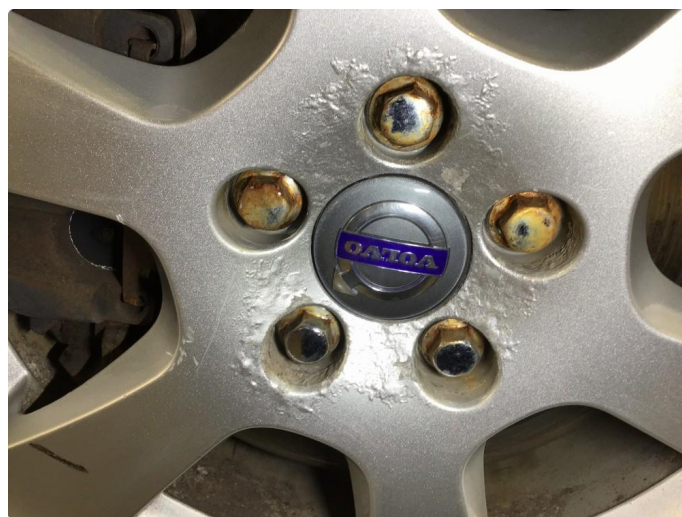
2.11 Korrosjon alle vinterfelger.
