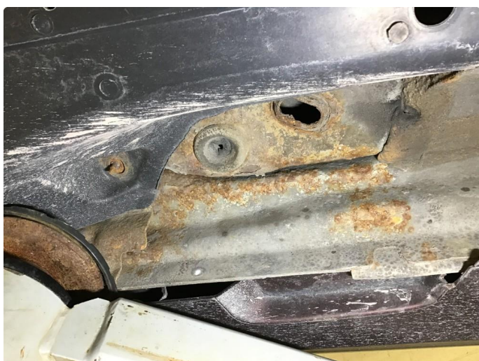
2.1 Rust underside ved bakstilling.
