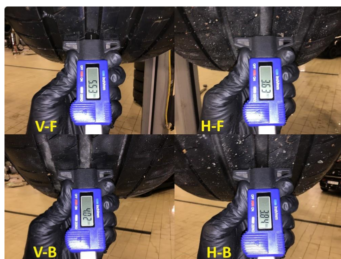
1.2 Mønsterdybde sommerdekk målt ved takst 23.10.2024, 51.500km. 2 Nye sommerdekk bak påsatt etter takst.
