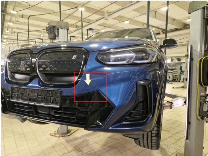
1.6 Noe riper / lakksår v-side frontfanger .
