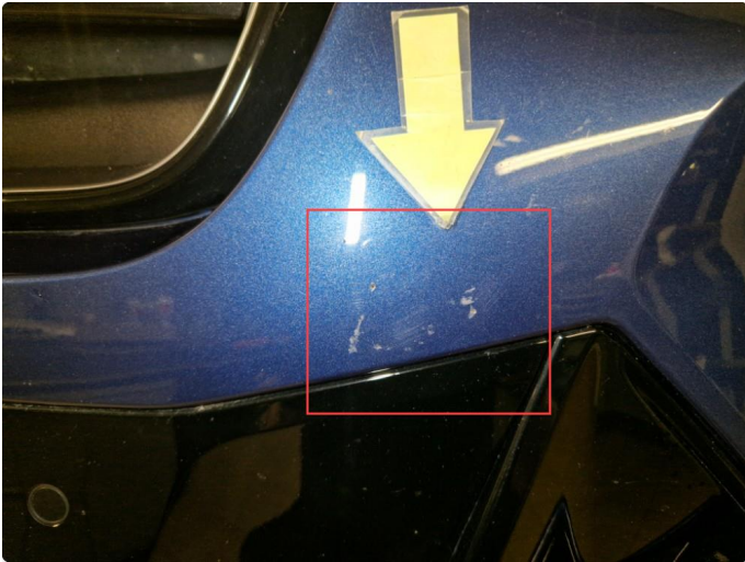
1.6 Noe riper / lakksår v-side frontfanger .
