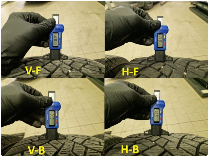
1.5 Dekkdybdemåling vinterdekk utført 04.07.2025 på km : 33164
