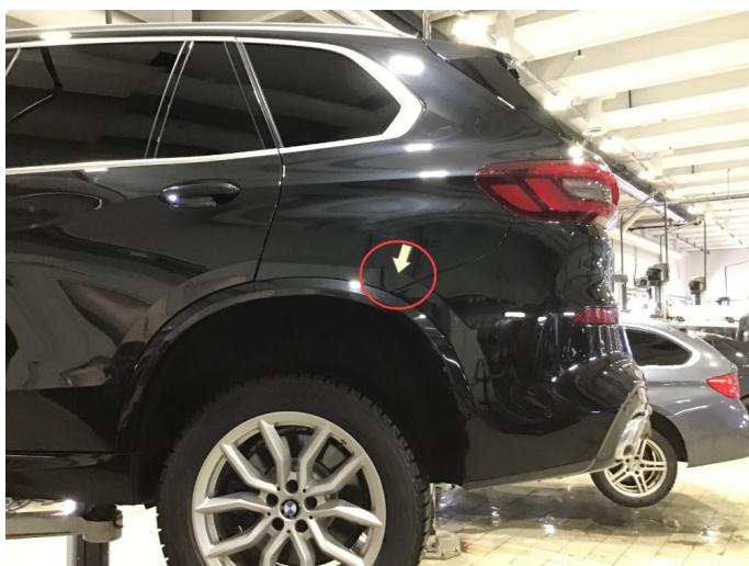
1.3 Liten p-bulk med lakksår v- baksjerm, er flekket.
