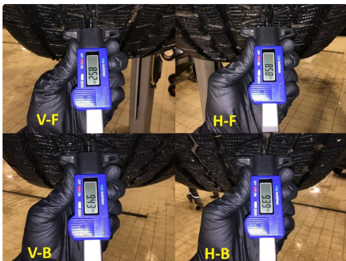
1.7 Mønsterdybde vinterdekk målt ved takst 08.01.2025, 124.404km.
