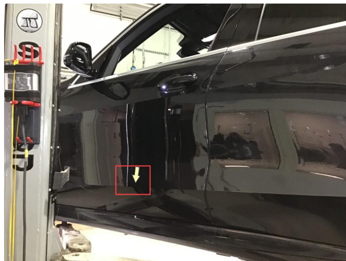
1.2 Lakksår v- framdør, er flekket tidligere.
