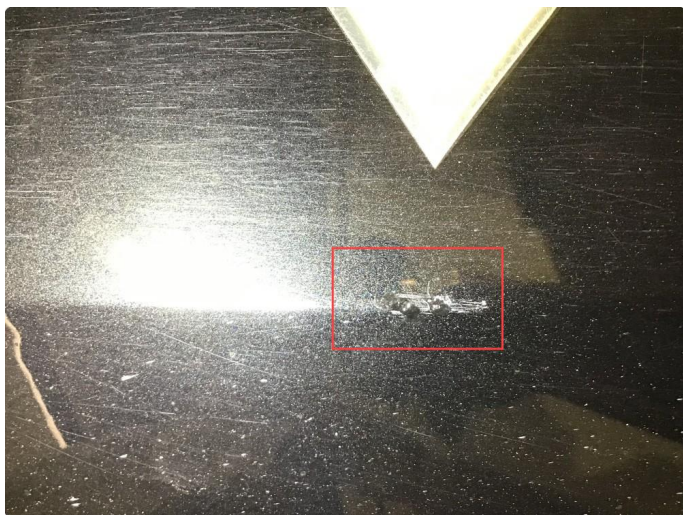
1.2 Lakksår v- framdør, er flekket tidligere.
