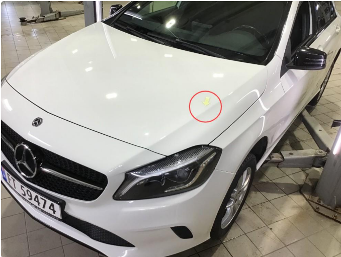
1.1 Liten bulk / fordykning v-side panser ( Normal bruksslitasje )
