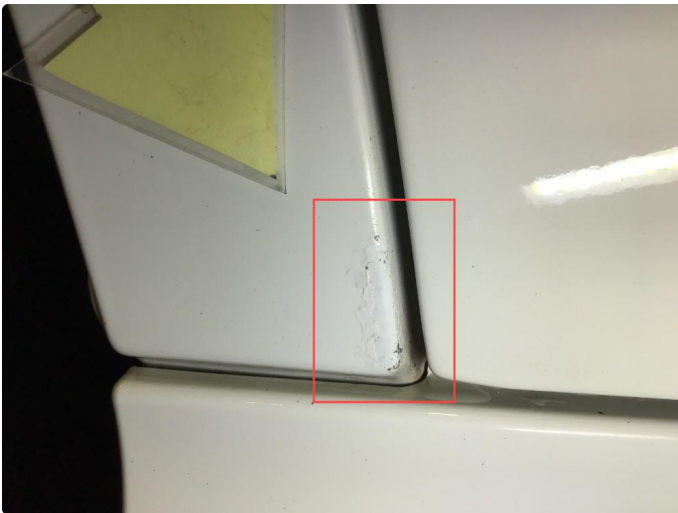
1.2 Lakksår h-bakskjerm/ hjulbue nedre del , er flekket tidligere.
