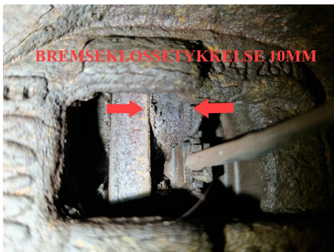
5.2 Rust / slitte bremseskiver bak , bremseklosser målt til 10mm.
