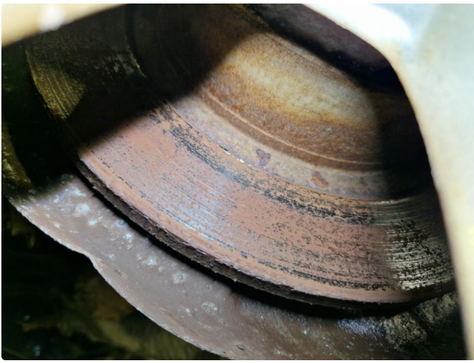
5.2 Rust / slitte bremseskiver bak , bremseklosser målt til 10mm.
