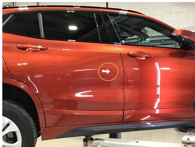
1.2 Liten p-bulk øvre del h-bakdør, regnes som normal bruksslitasje.
