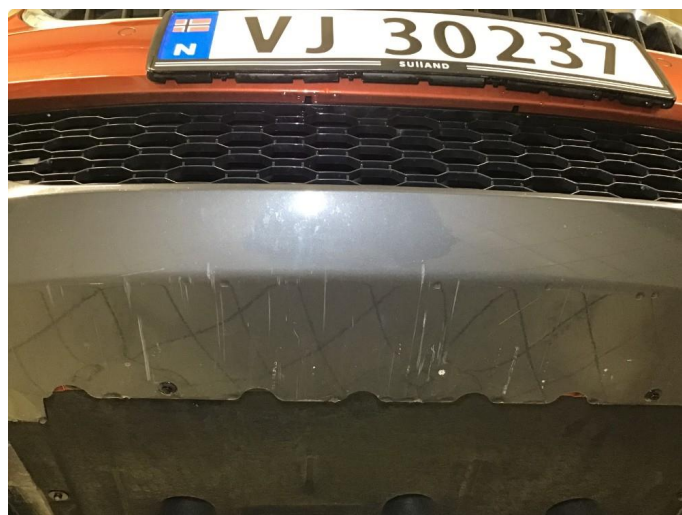
1.8 Skrubbermerker underkant framfanger, regnes som normal bruksslitasje.
