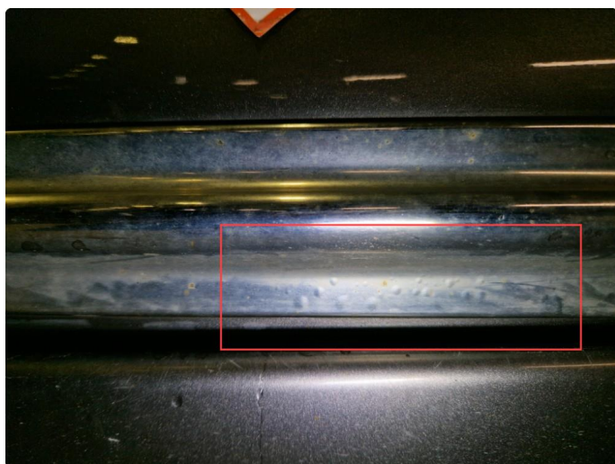
1.6 Korrosjon nedre chromelist alle dører.
