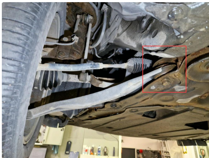
4.4 Slitt bakre bærearmsforing / sluppet i vulking h+v side fram.
