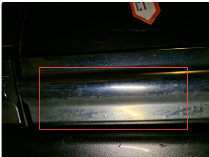
1.6 Korrosjon nedre chromelist alle dører.
