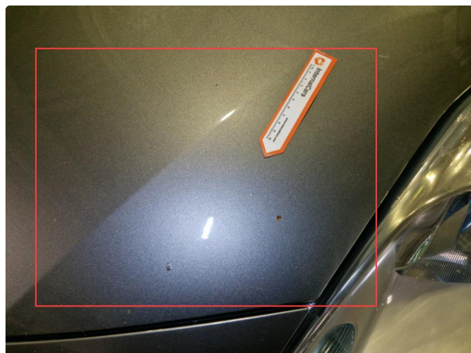
1.1 Flere små steinsprut med rustdannelser panser.
