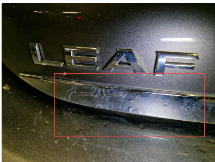
1.7 Korrosjon chromelist bakluke.
