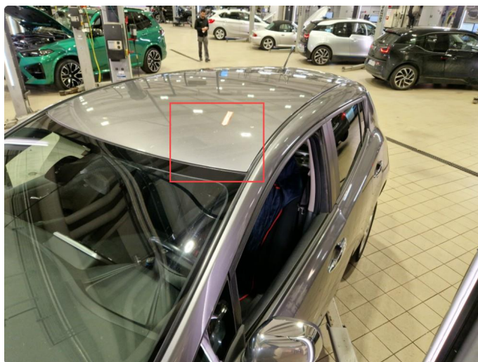
1.16 Steinsprut med rustdannelser fremre del tak.
