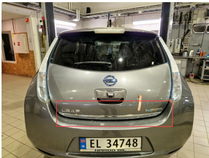
1.7 Korrosjon chromelist bakluke.
