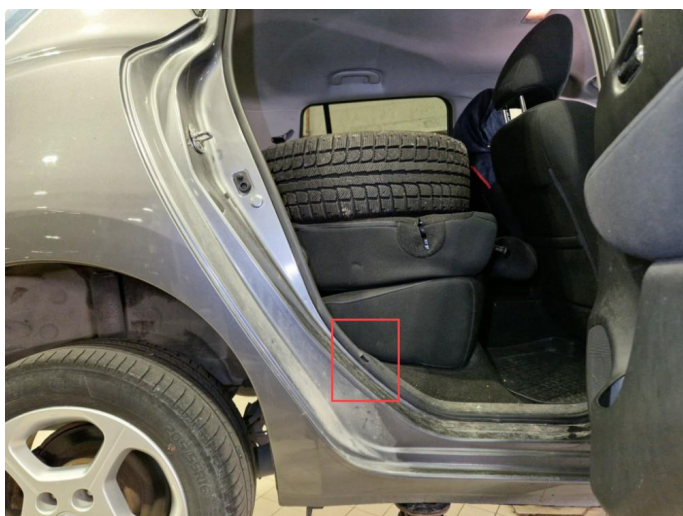
1.5 Skadet dørkarmlist h-bak.
