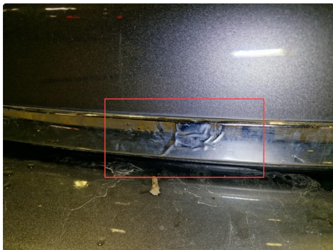
1.7 Korrosjon chromelist bakluke.
