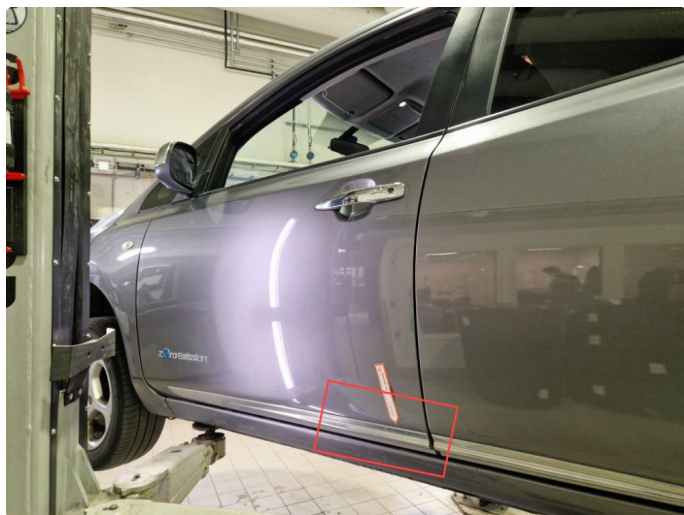
1.6 Korrosjon nedre chromelist alle dører.
