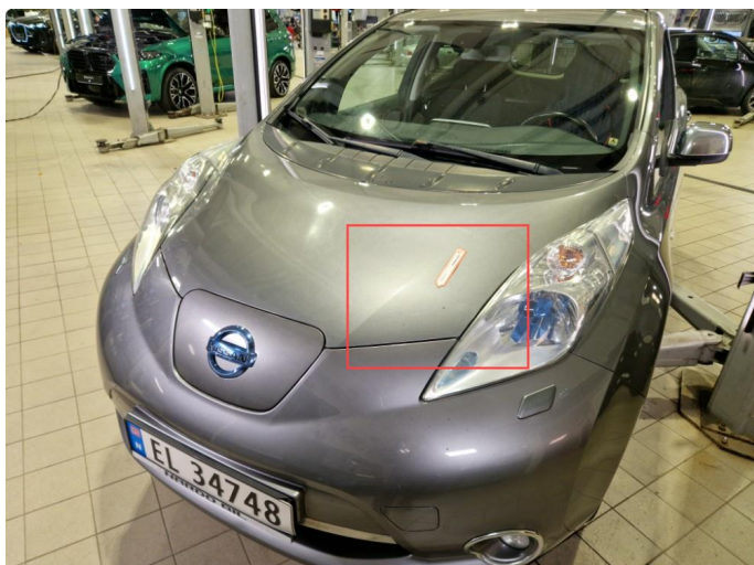
1.1 Flere små steinsprut med rustdannelser panser.
