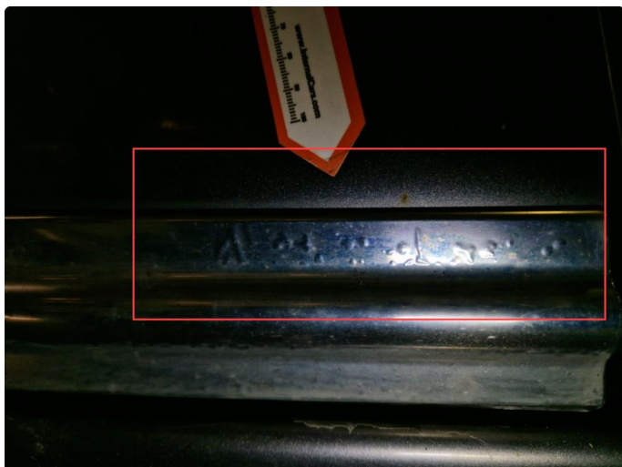
1.6 Korrosjon nedre chromelist alle dører.
