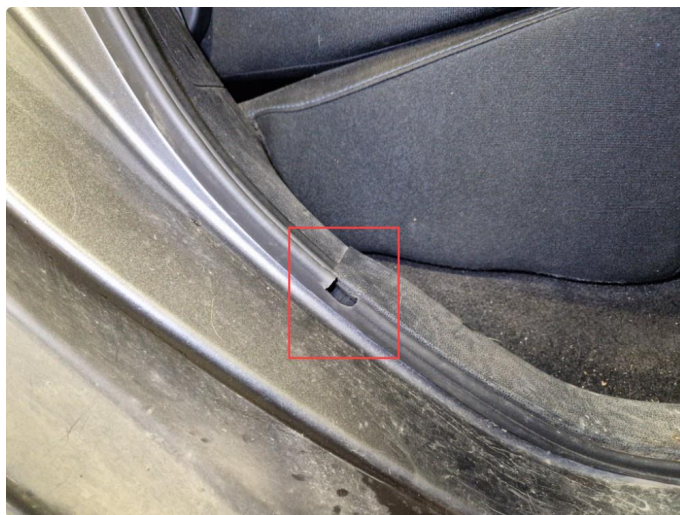
1.5 Skadet dørkarmlist h-bak.
