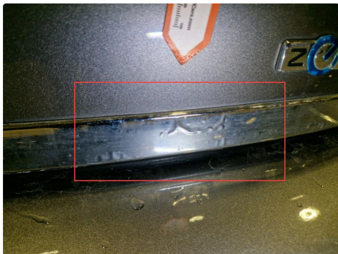
1.7 Korrosjon chromelist bakluke.
