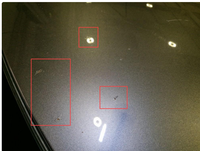
1.16 Steinsprut med rustdannelser fremre del tak.
