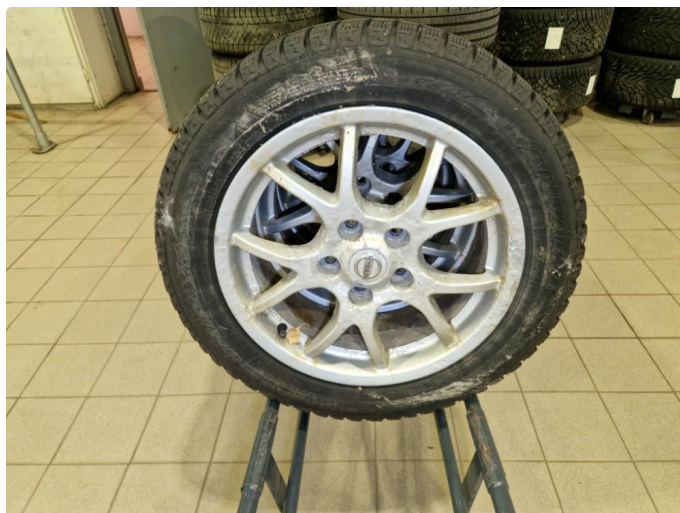
1.13 Korrosjon alle vinterfelger.
