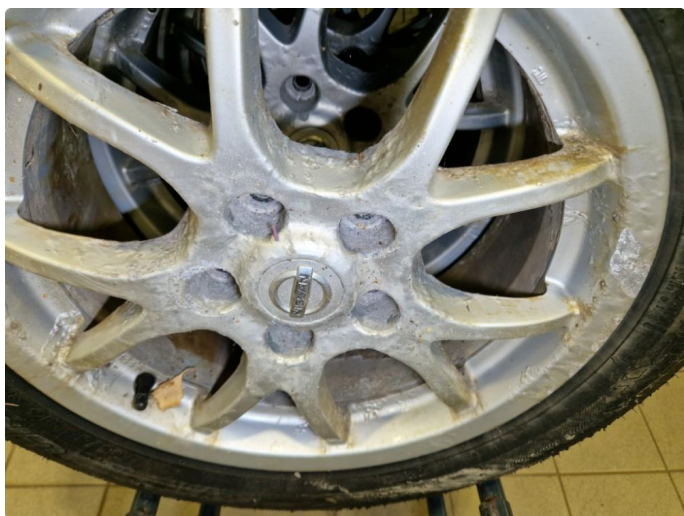
1.13 Korrosjon alle vinterfelger.
