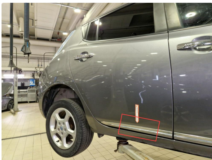
1.6 Korrosjon nedre chromelist alle dører.
