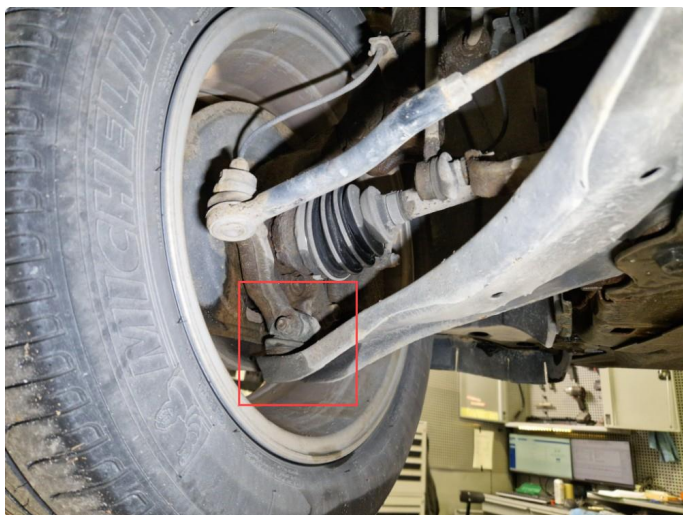
4.3 Slakke nedre opphengskule h+v side fram.
