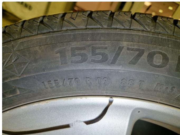
1.1 Vinterdekk produsert 35/2019 + skadet dekkskulder 1 stk vinterdekk. Continental Viking Contact 7 155/70R 19 88T Piggfri.
