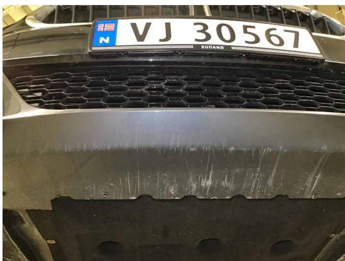
1.8 Skrubbemerker underkant fremfanger, regnes som normal bruksslitasje.
