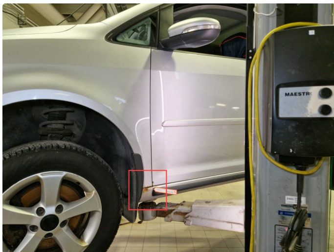
1.13 Rustdannelser fremre del kanal h+v side.
