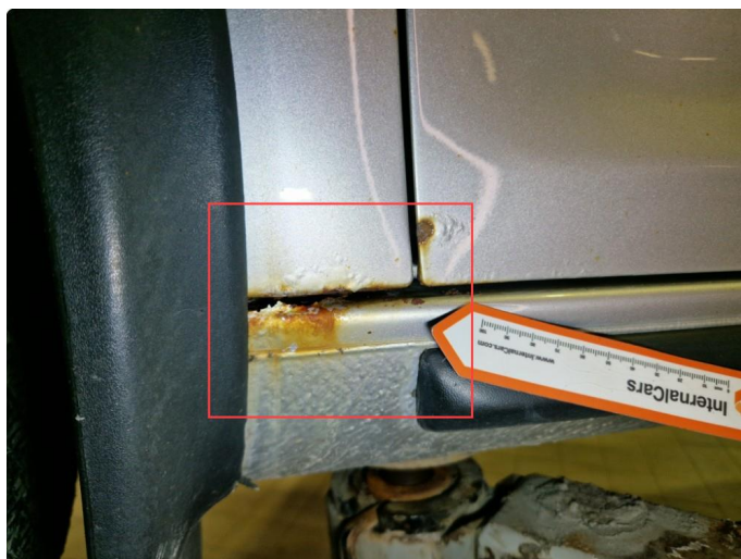
1.13 Rustdannelser fremre del kanal h+v side.
