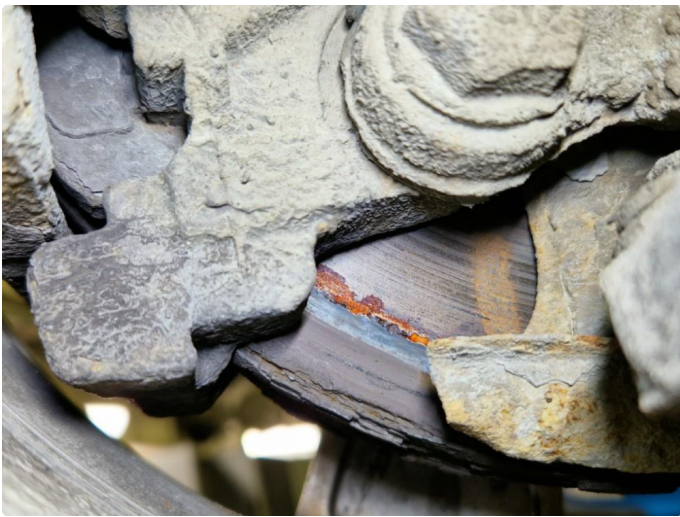
5.1 Slitte / stor slitekant + rust bremseskiver fram , bremseklosser målt til 7mm.
