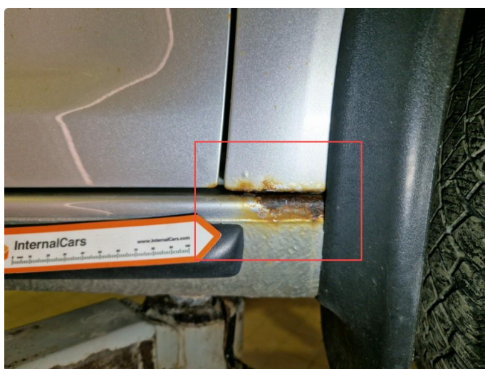
1.13 Rustdannelser fremre del kanal h+v side.
