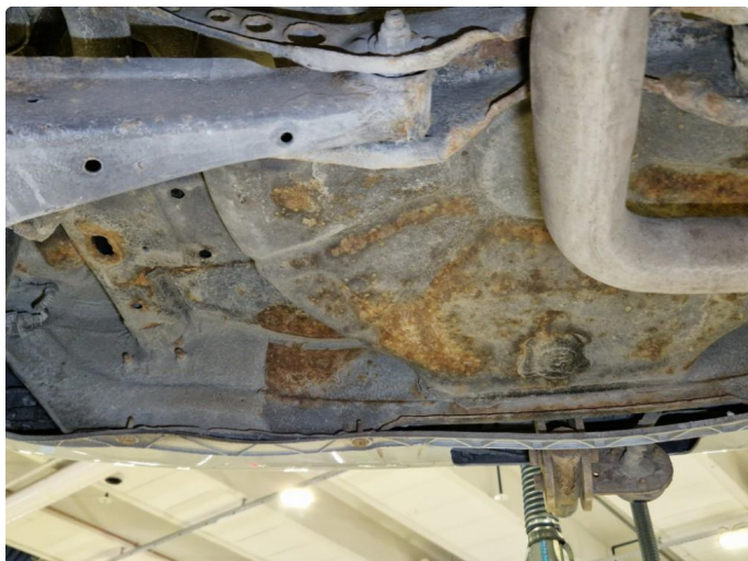
1.1 Noe rustdannelser ved bakstilling.
