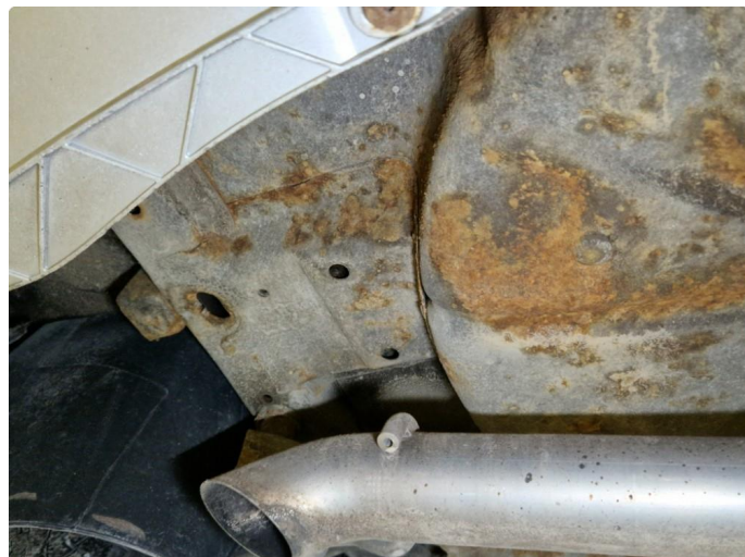
1.1 Noe rustdannelser ved bakstilling.
