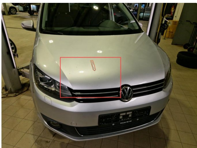
1.2 Flere små steinsprut panser
