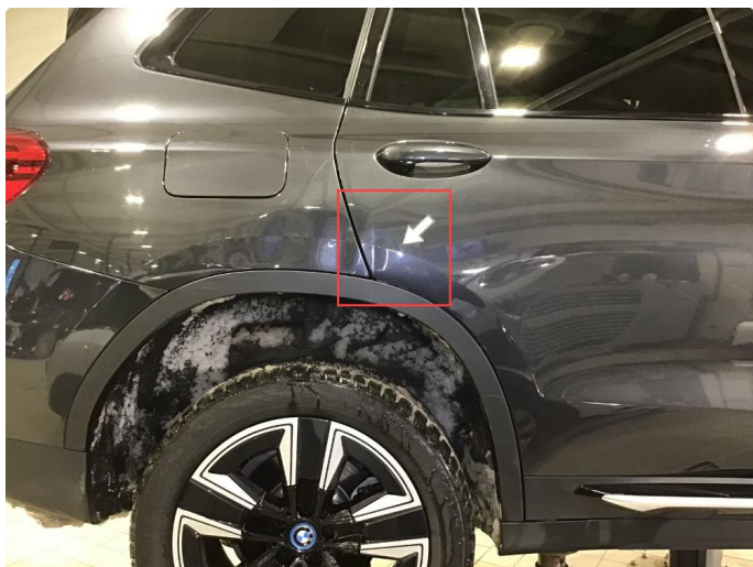
1.2 Tidligere bulker på h-bakdør og h-bakskjerm, dette er rettet hos oss etter BMWs retningslinjer.
