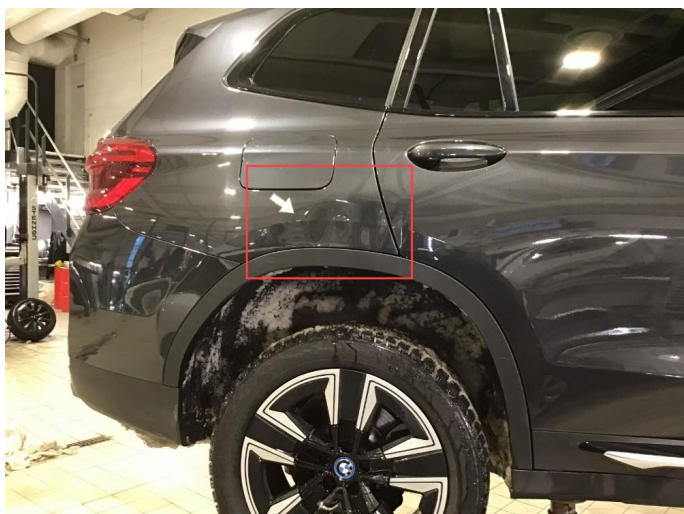
1.3 Tidligere bulker på h-bakdør og h-bakskjerm, dette er rettet hos oss etter BMWs retningslinjer.
