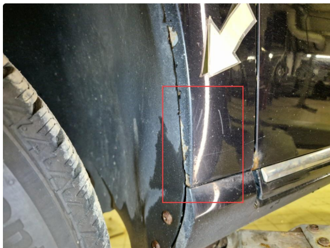
1.6 Rust + bulk v-framskjerm, rust hframskjerm.
