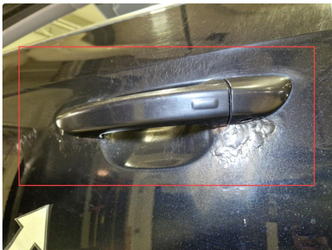
1.3 Rust h+v framdør.
