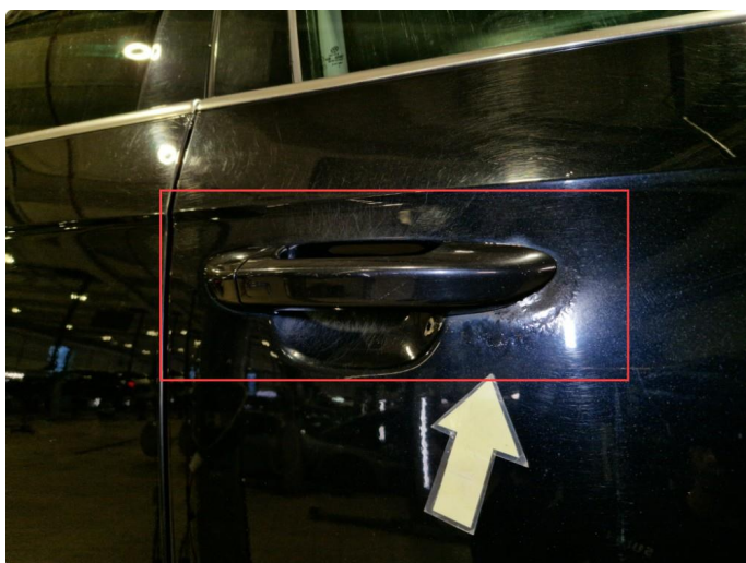
1.3 Rust h+v framdør.
