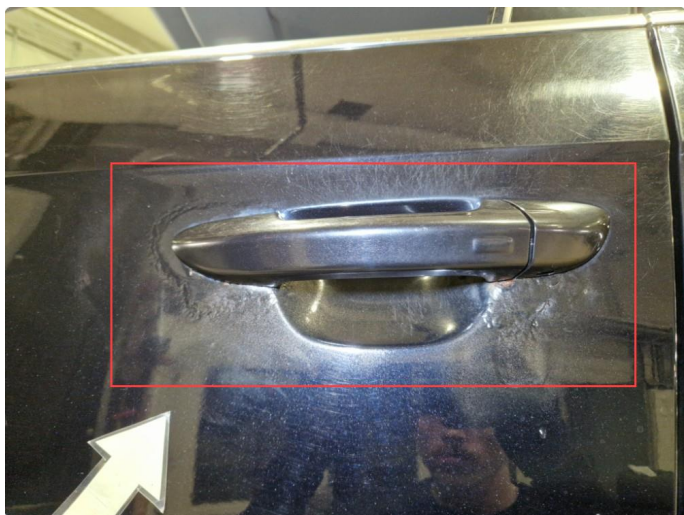
1.3 Rust h+v framdør.
