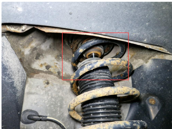
4.1 Defekt støtdempersjett h+v fram , sprukket øvre del.
