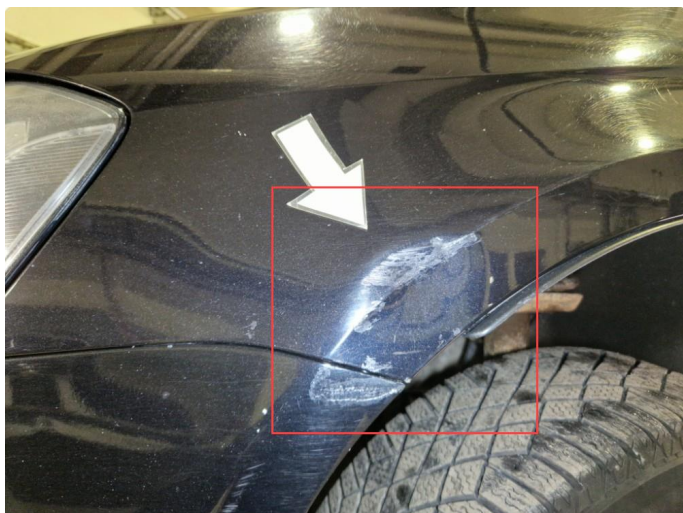
1.6 Rust + bulk v-framskjerm, rust hframskjerm.
