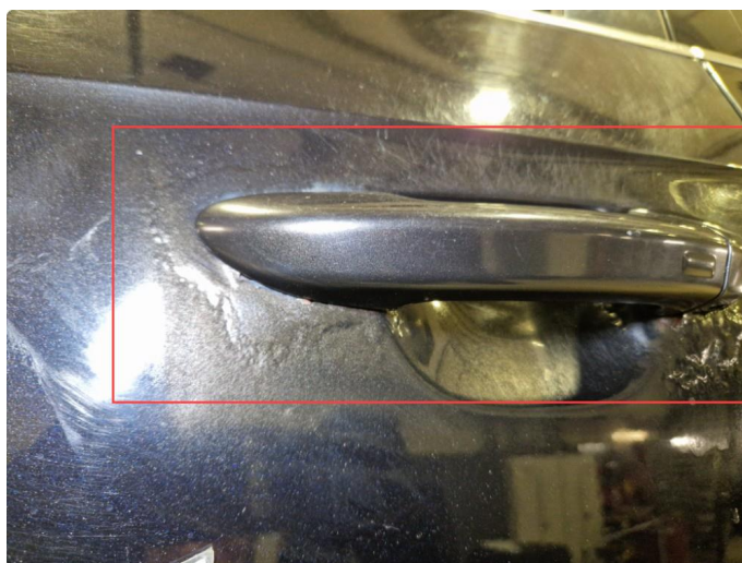
1.3 Rust h+v framdør.
