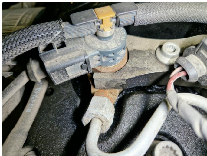
3.5 Lekkasje 2 stk dyser.
