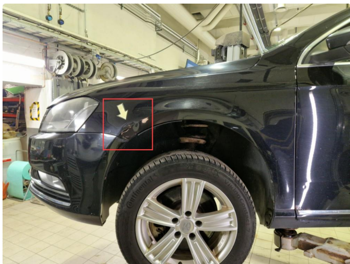
1.6 Rust + bulk v-framskjerm, rust hframskjerm.
