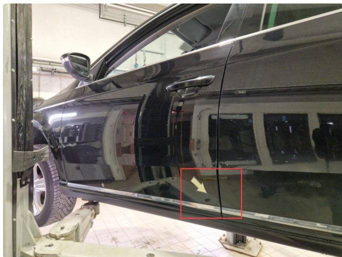
1.3 Rust h+v framdør.
