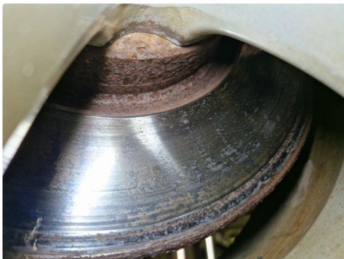
5.1 Svak pulsering bremseskiver fram + rust / slitasje.
