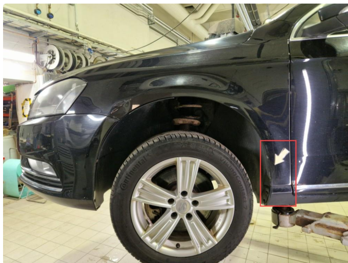
1.6 Rust + bulk v-framskjerm, rust hframskjerm.
