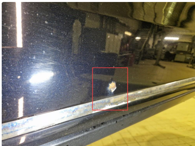
1.3 Rust h+v framdør.
