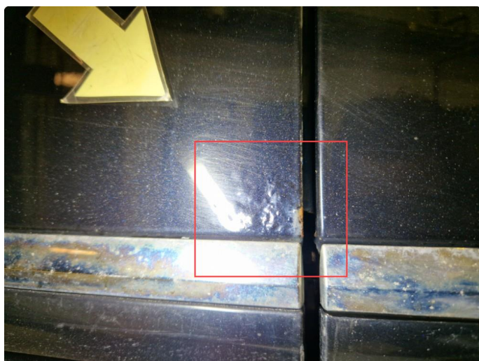
1.3 Rust h+v framdør.
