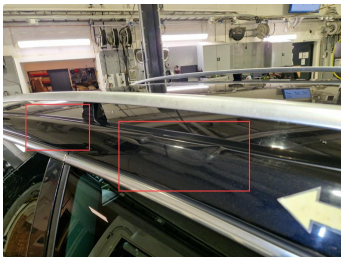
1.12 Rust fremre del h-side tak + bulker bakre del v-side.
