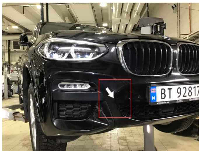
2.3 Noen riper på fremfanger, flikkes og poleres.
