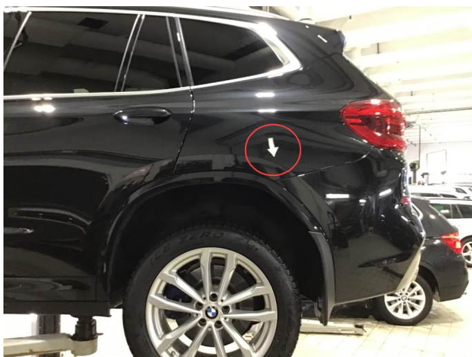
2.2 Liten p-bulk v-bakskjerm, regnes som normal bruksslitasje.
