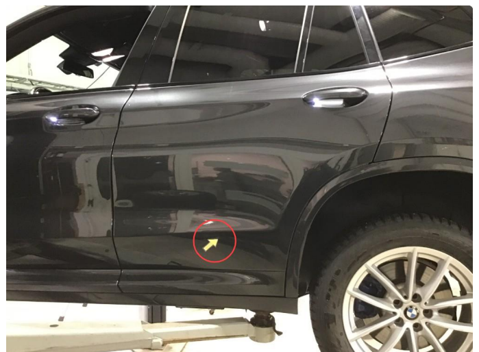
1.2 Liten p-bulk v-bakdør ( Normal bruksslitasje )
