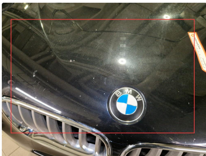
2.2 Mye steinsprut / lakkslitasje panser.
