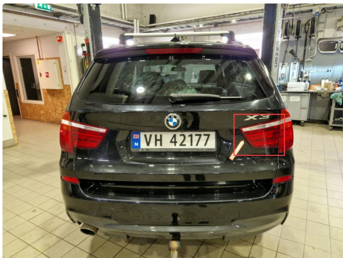
3.1 Fukt indre baklykt h+v side.
