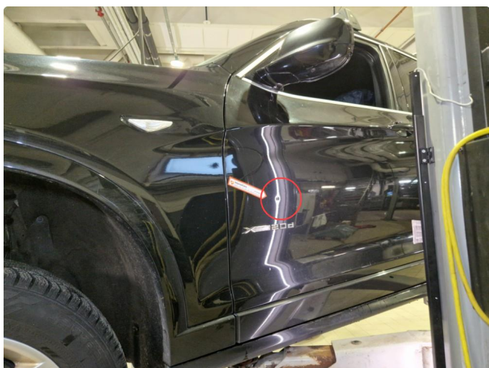
2.3 Rustbabler + p-bulk v-framdør.
