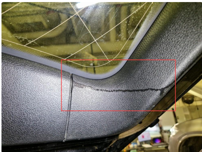
2.8 Lekkasje bakluke, trolig gjennom midtre bremselykt.
