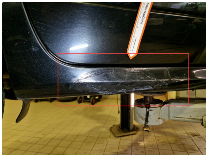
2.17 Skade bakre del kanalskjørt h-side.
