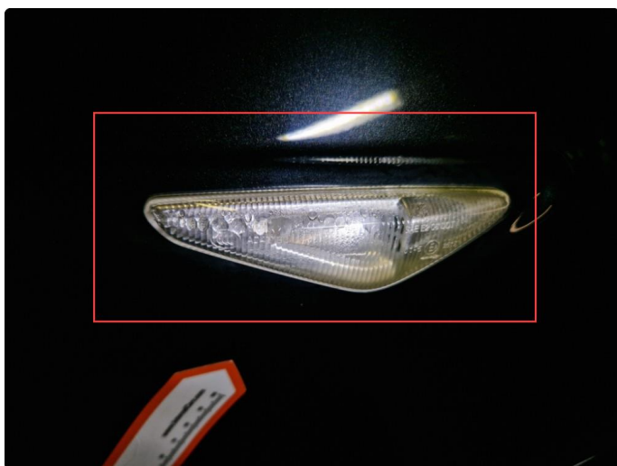
3.2 Fukt blinklykt h+v framskjerm.
