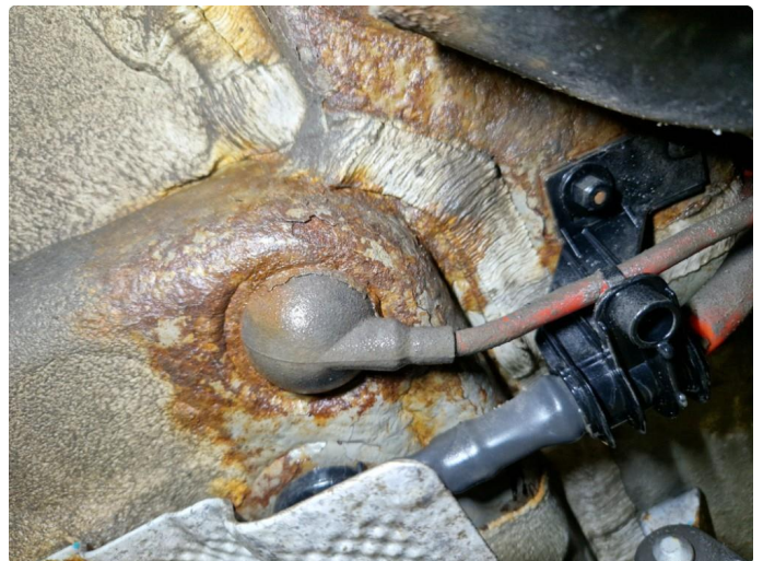
2.1 Noe rust underside ved bakstilling.
