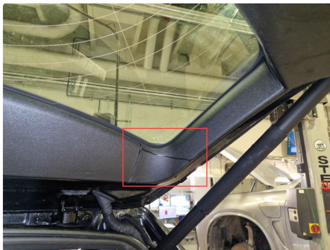
2.8 Lekkasje bakluke, trolig gjennom midtre bremselykt.
