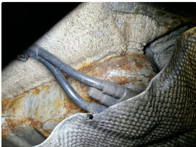
2.1 Noe rust underside ved bakstilling.
