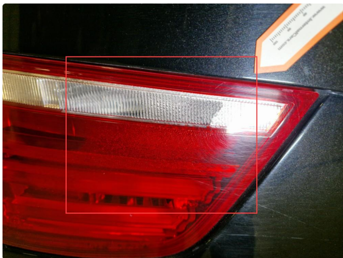
3.1 Fukt indre baklykt h+v side.
