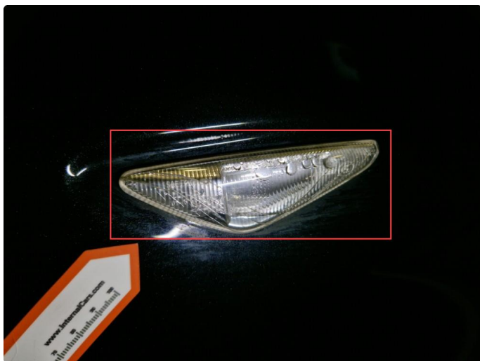
3.2 Fukt blinklykt h+v framskjerm.
