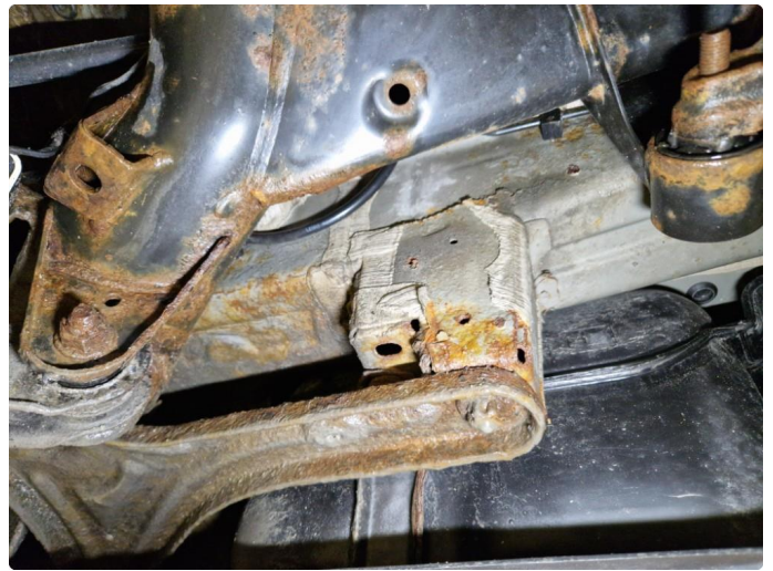
2.1 Noe rust underside ved bakstilling.
