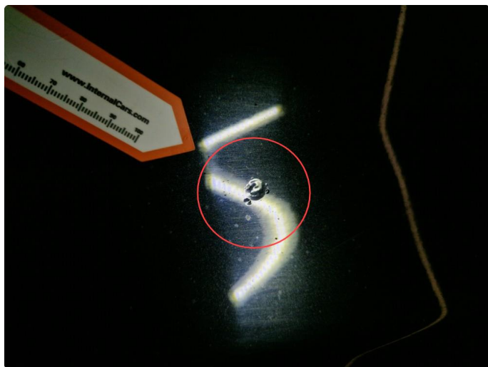
2.3 Rustbabler + p-bulk v-framdør.
