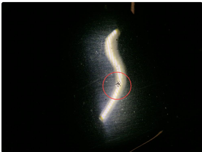
2.3 Rustbabler + p-bulk v-framdør.
