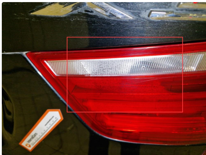
3.1 Fukt indre baklykt h+v side.
