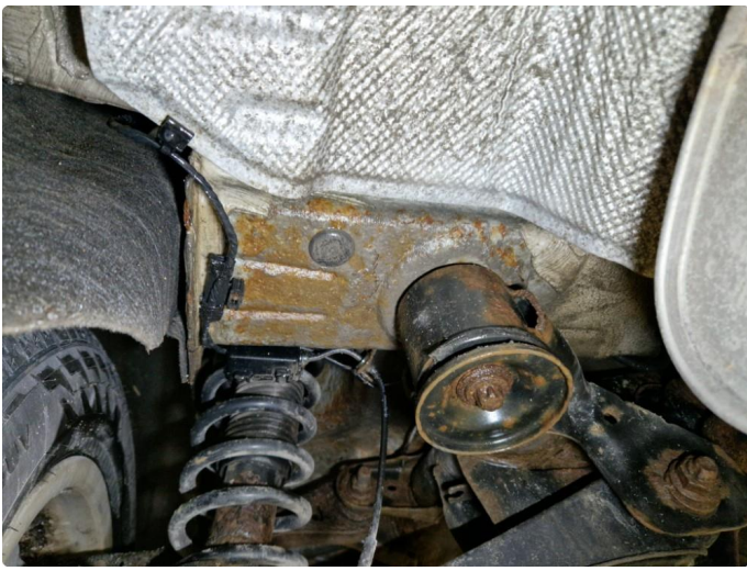
2.1 Noe rust underside ved bakstilling.
