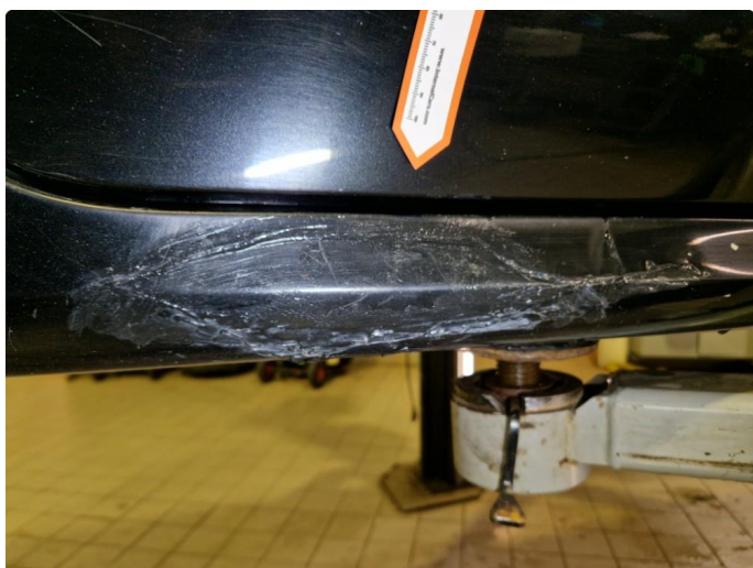
2.17 Skade bakre del kanalskjørt h-side.
