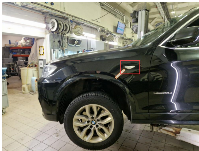
3.2 Fukt blinklykt h+v framskjerm.
