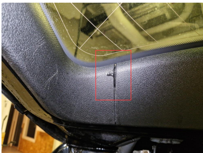
2.8 Lekkasje bakluke, trolig gjennom midtre bremselykt.
