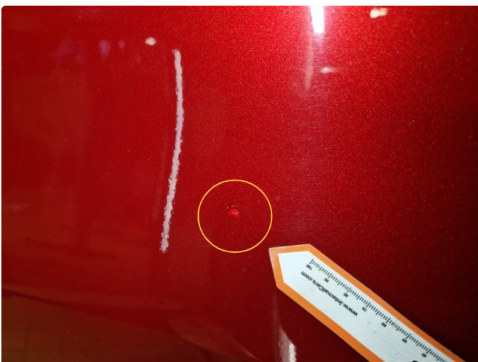
1.3 Lakksår h-framdør, er flekket . ( Normal bruksslitasje ).
