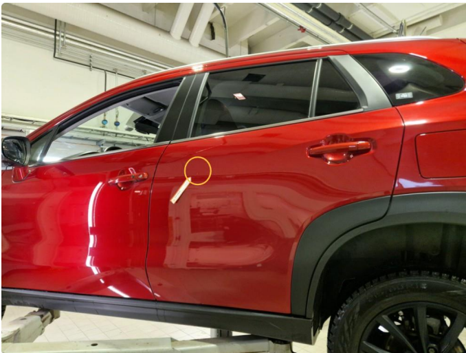
1.2 Lakksår v-bakdør, er flekket. ( Normal bruksslitasje ).
