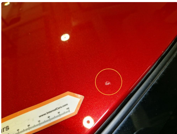
1.6 1 Stk lakksår / steinsprut fremre del tak, er flekket. ( Normal bruksslitasje ).
