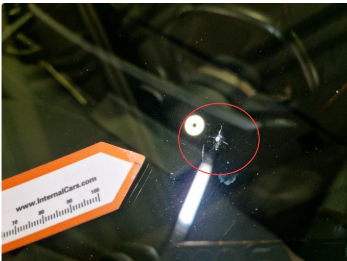
1.2 Steinsprut er reparert.
