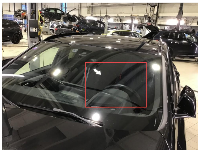
1.5 Noe steinsprut frontrute, for små til å repareres.
