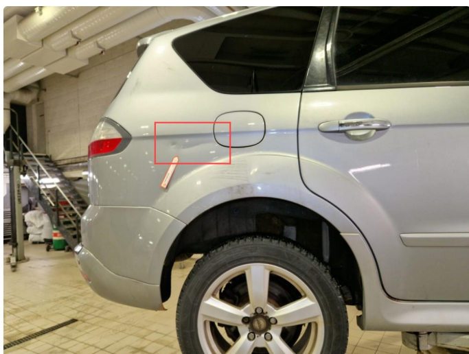
1.4 Rust / bruksmerker / bulker alle 4 stk skjermer.
