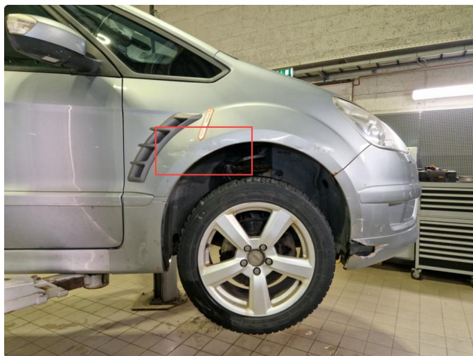
1.4 Rust / bruksmerker / bulker alle 4 stk skjermer.
