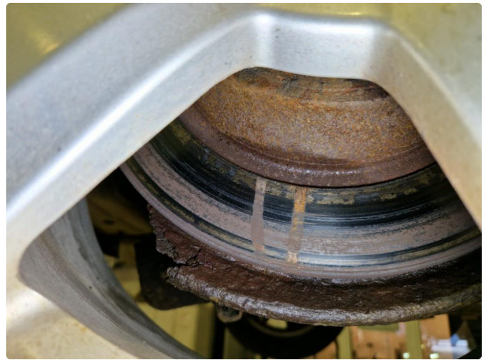
5.1 Bremsler henger på h-side bak, varmkjørt bremseskive / klosser .
