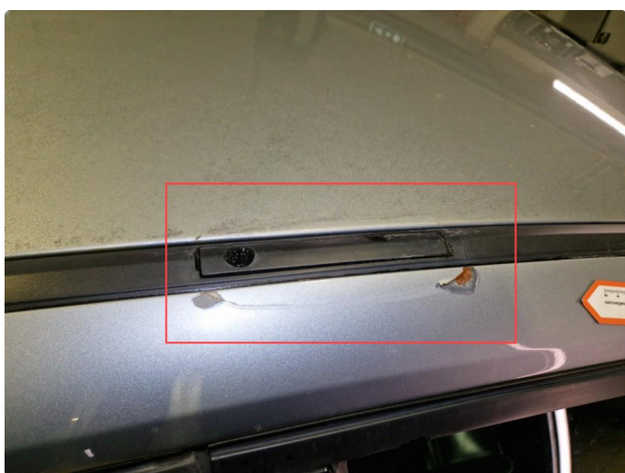
1.8 Rustdannelser ved innfesting til lasteholdere + bulker tak.
