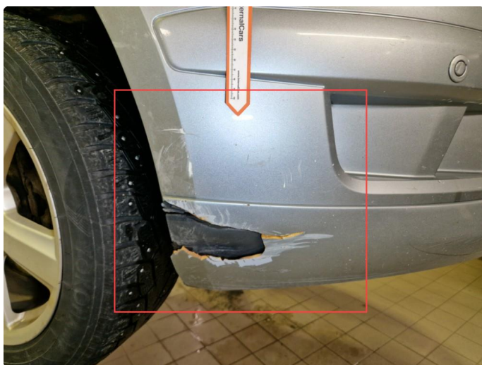
1.7 Skader / bruksmerker frontfanger og bakfanger.
