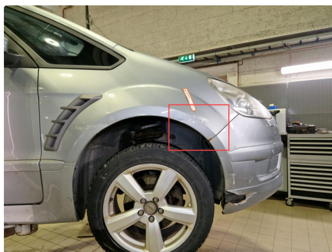
1.4 Rust / bruksmerker / bulker alle 4 stk skjermer.
