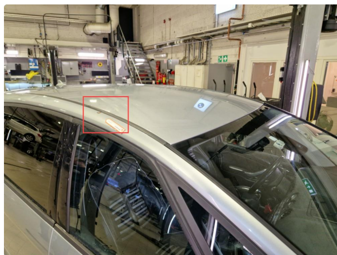
1.8 Rustdannelser ved innfesting til lasteholdere + bulker tak.
