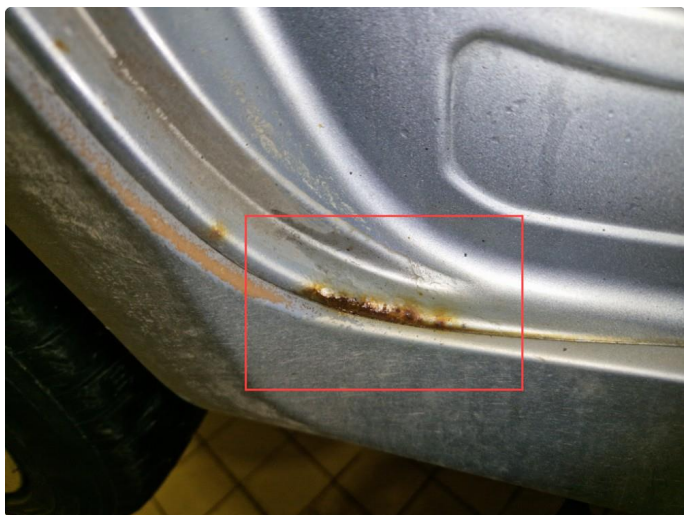
1.9 Rustdannelser bakre del kanal h+v side.
