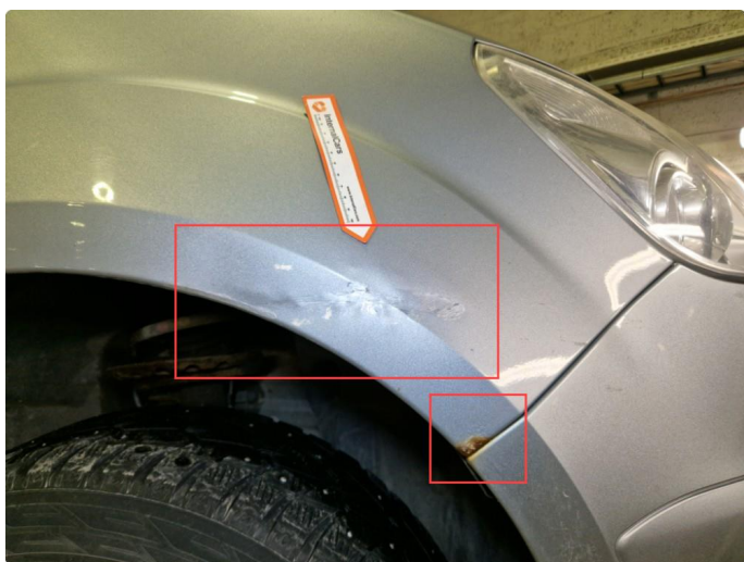
1.4 Rust / bruksmerker / bulker alle 4 stk skjermer.
