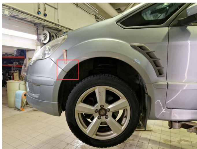
1.4 Rust / bruksmerker / bulker alle 4 stk skjermer.
