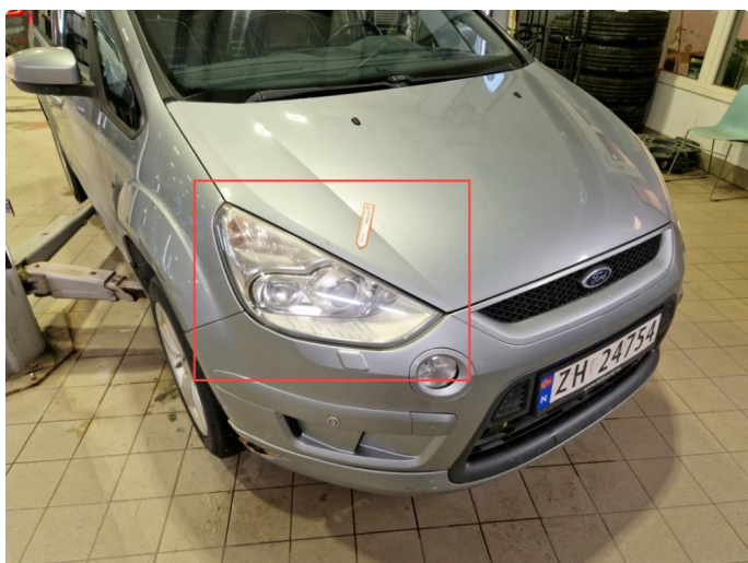
2.1 Matte lykteglass hovedlykt h+v side fram , påvirkker lysbilde / styrke.
