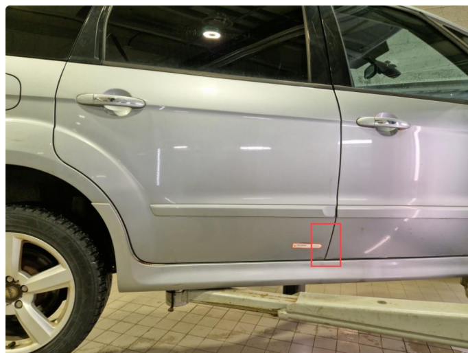
1.2 Små bulker / rustdannelser og bruksmerker alle 4 stk dører.
