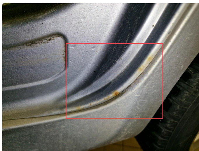
1.9 Rustdannelser bakre del kanal h+v side.
