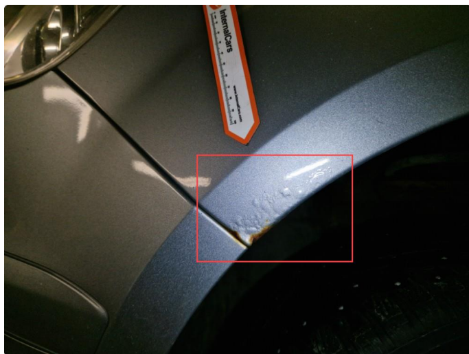
1.4 Rust / bruksmerker / bulker alle 4 stk skjermer.
