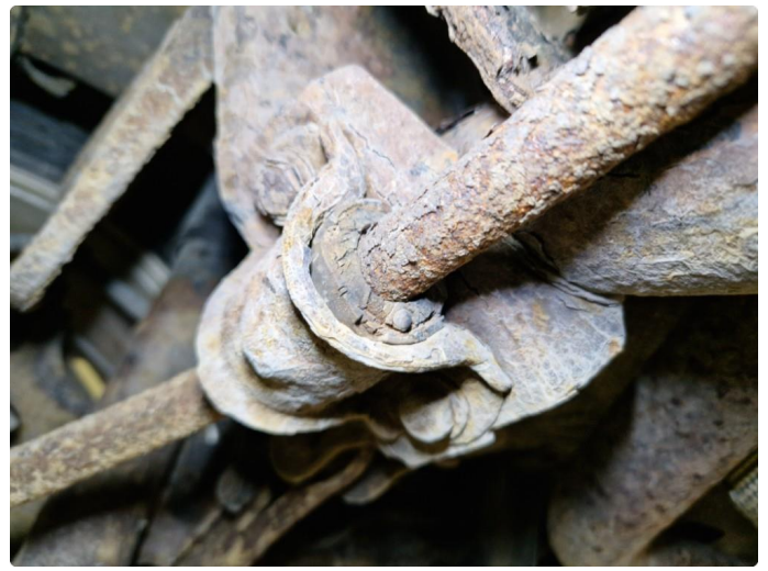
4.2 Slitte stabstagforinger h+v side bak.
