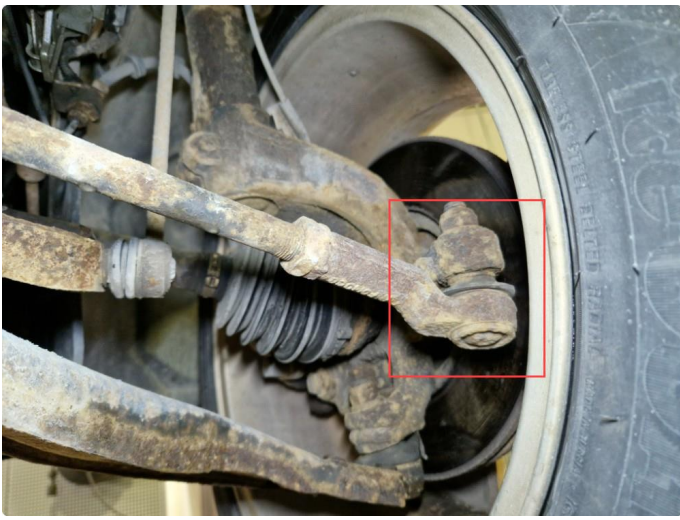
4.1 Slakke ytre styreledd h-side .
