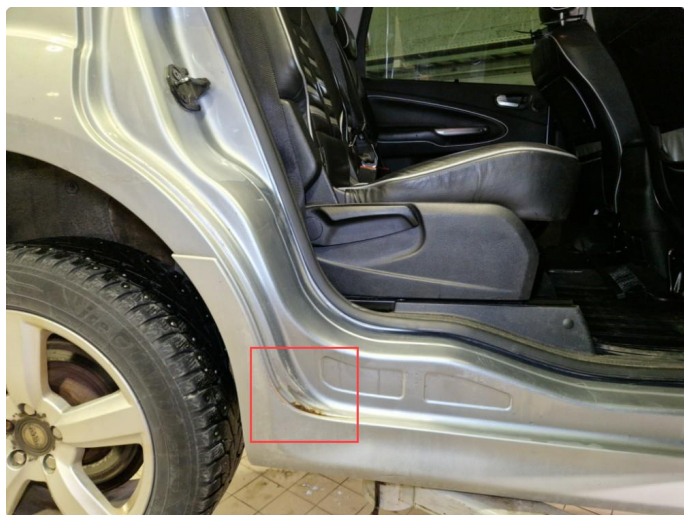
1.9 Rustdannelser bakre del kanal h+v side.
