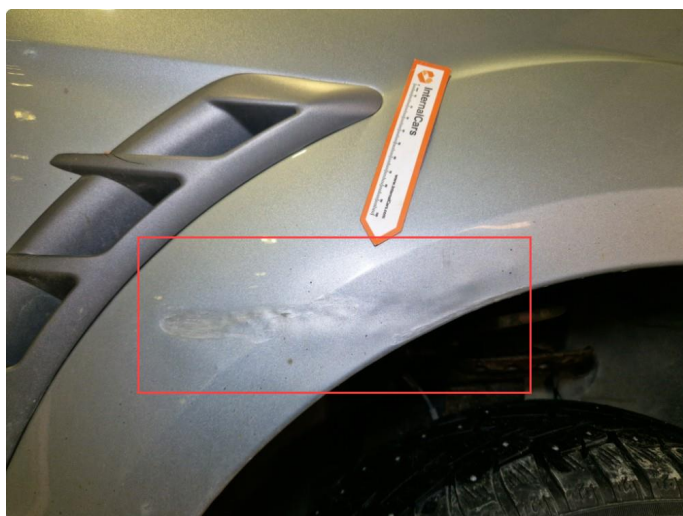
1.4 Rust / bruksmerker / bulker alle 4 stk skjermer.
