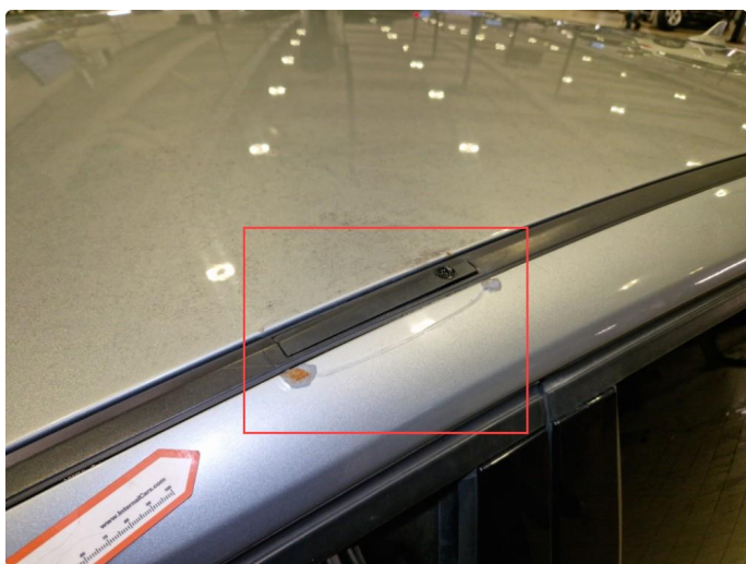
1.8 Rustdannelser ved innfesting til lasteholdere + bulker tak.
