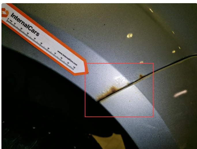
1.4 Rust / bruksmerker / bulker alle 4 stk skjermer.
