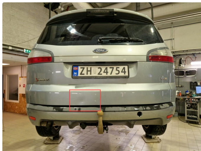
1.3 Bulker / bruksmerker bakluke.
