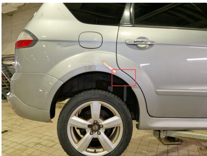
1.4 Rust / bruksmerker / bulker alle 4 stk skjermer.
