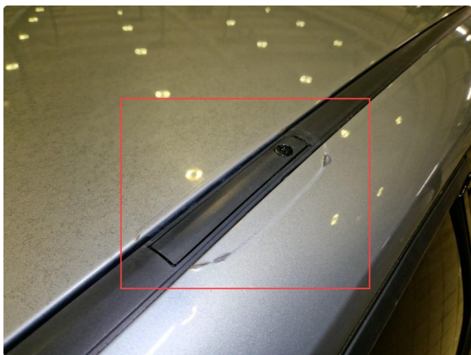
1.8 Rustdannelser ved innfesting til lasteholdere + bulker tak.
