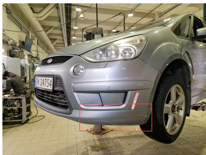
1.7 Skader / bruksmerker frontfanger og bakfanger.
