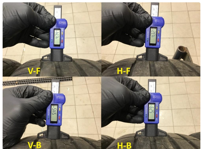
1.3 Mønsterdybde sommerdekk målt ved takst 04.11.2024, 43.366km.
