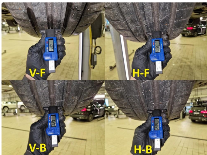
1.1 Mønsterdybde sommerdekk målt ved takst 15.08.2025, 60.045km.
