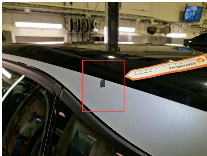
3.11 Skadet dekor h+v side ved tak.
