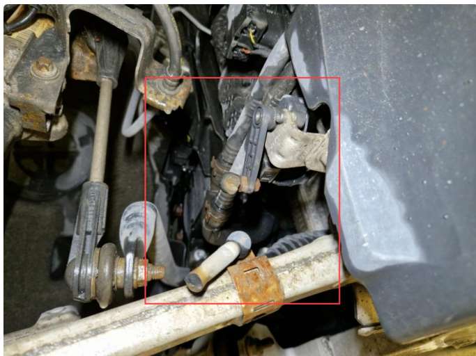
2.1 Skadet stag til nivåsensor v-fram.
