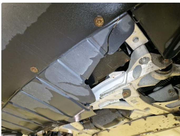
3.1 Skadet fremre midtre beskyttelsesplate.
