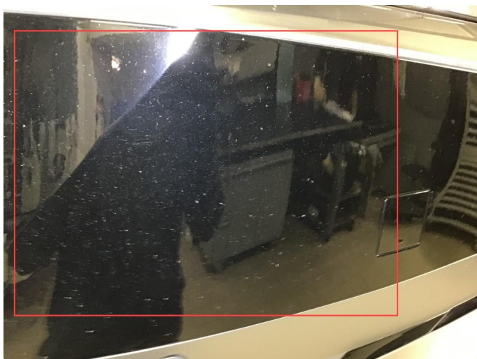
1.4 Noe steinsprut på frontfanger.
