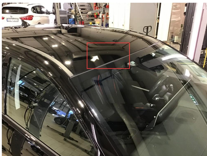
1.5 Steinsprut h-fremre del tak + bulk v -bakre del.
