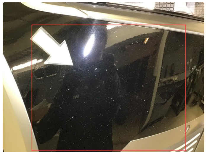
1.4 Noe steinsprut på frontfanger.
