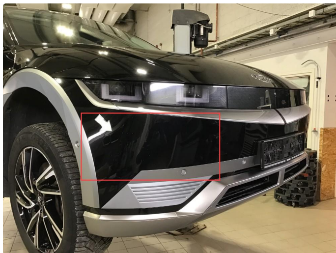
1.4 Noe steinsprut på frontfanger.
