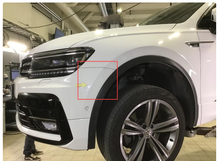
1.4 Lakksår v-side frontfanger , normal bruksslitasje .
