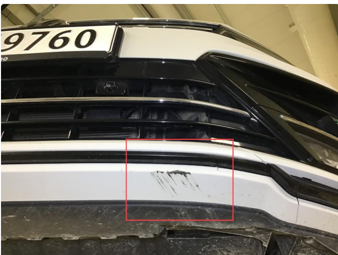
1.3 Skrubbskader underkant , normal bruksslitasje.
