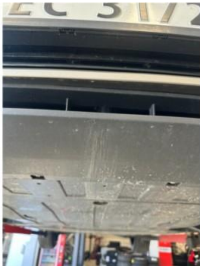
1.4 Litt oppripet på underside av fanger foran
