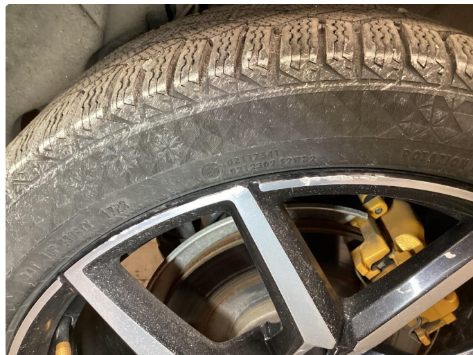
1.2 Kantkjørt felg (Reparert)
