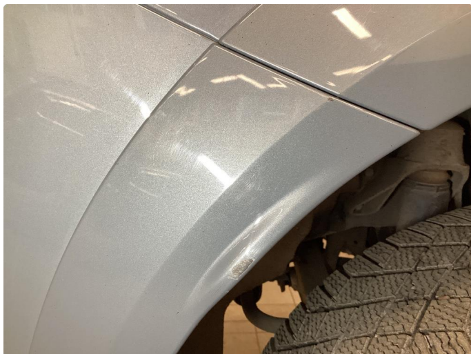
1.1 Skjermutbygger skadet (Reparert)
