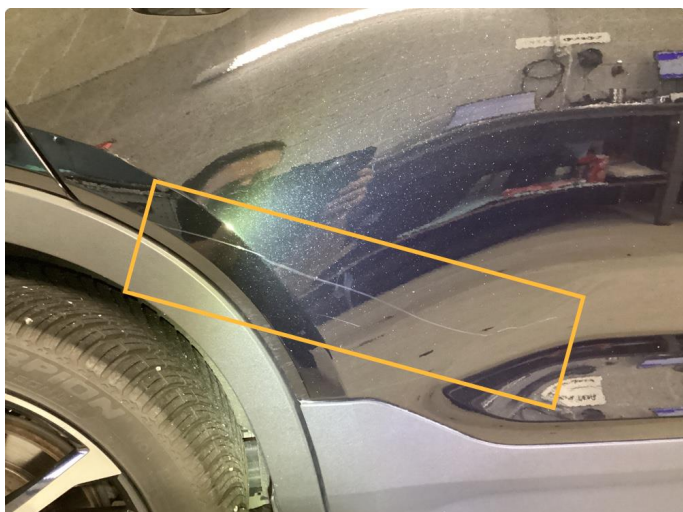
1.1 Ripe ned til grunning (Reparert)
