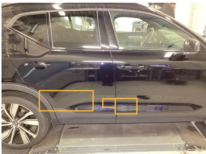
1.1 Ripe ned til grunning (Reparert)
