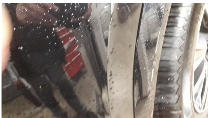
1.3 Ripe(r) ned til grunning (Reparert)
