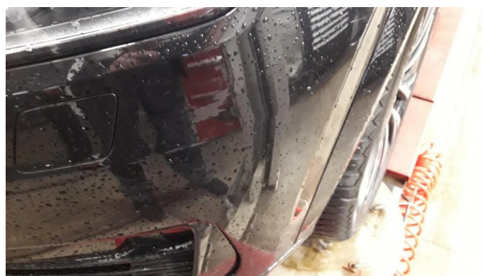
1.3 Ripe(r) ned til grunning (Reparert)
