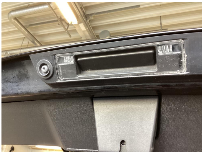
2.1 Krakelering i plast (Byttet)
