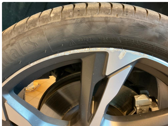
1.2 Skade på felg (repareres)
