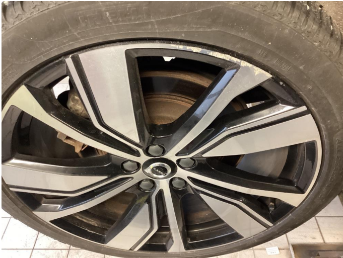
1.1 Kantkjørt felg (Reparert)
