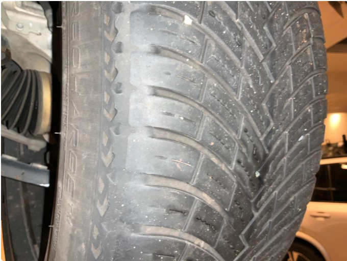
1.1 Skjev slitasje på sommerdekk (utbedres)
