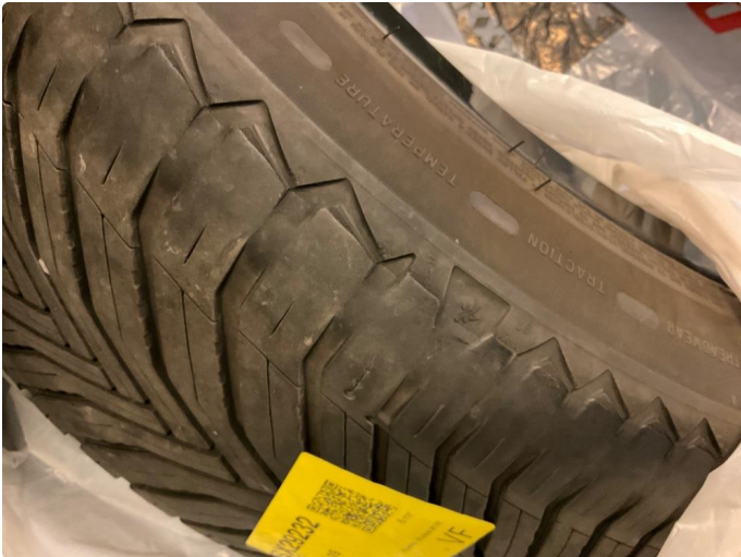
1.1 Skjev slitasje på sommerdekk (Utbedres)
