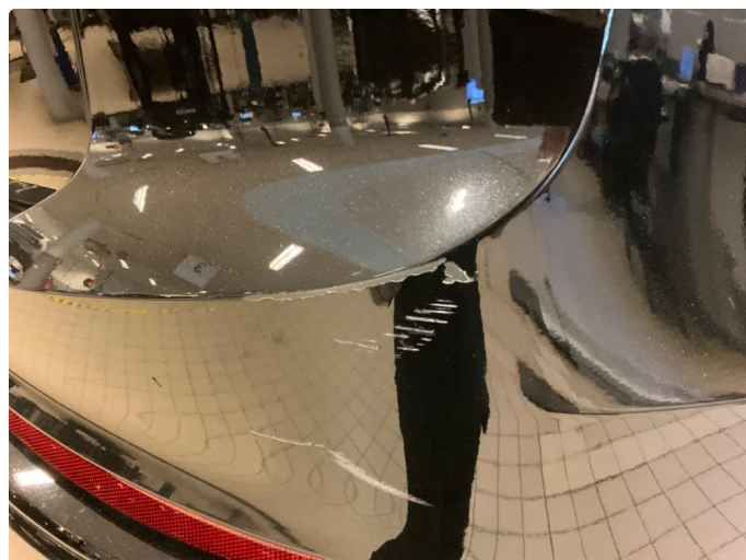
1.1 Ripe(r) ned til grunning (Reparert)
