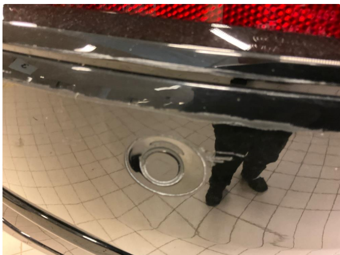
1.1 Ripe(r) ned til grunning (Reparert)
