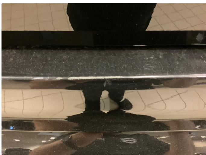
1.1 Ripe(r) ned til grunning (Reparert)
