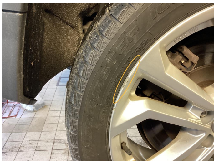
1.3 Skade på felg (Reparert)
