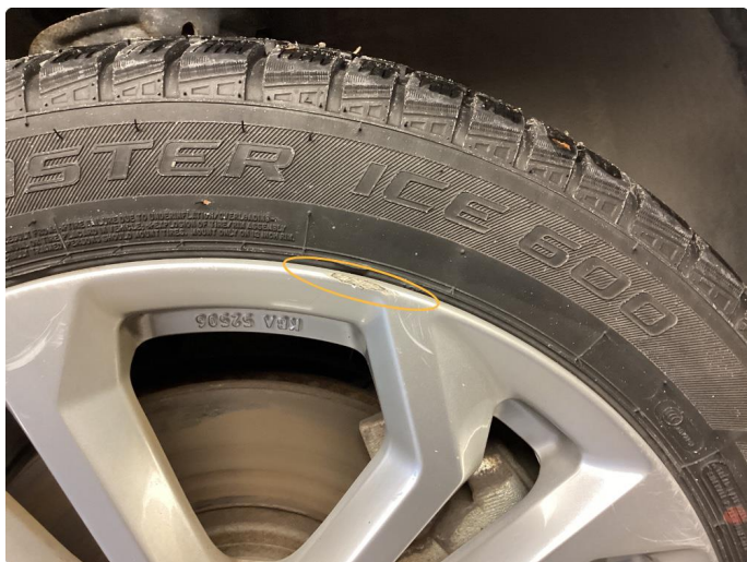
1.3 Skade på felg (Reparert)
