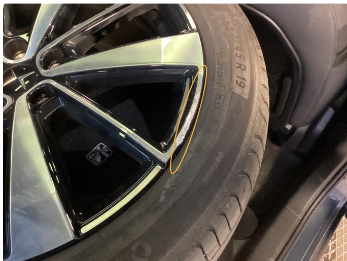
1.3 Skade på felg (Reparert)
