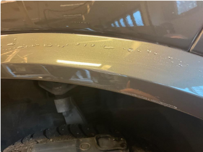
1.2 Ripe(r) ned til grunning (Utbedres)
