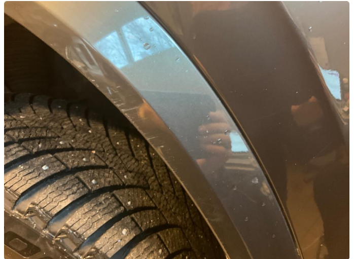
1.2 Ripe(r) ned til grunning (Utbedres)
