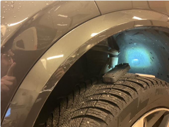
1.1 Ripe(r) ned til grunning (Utbedres)
