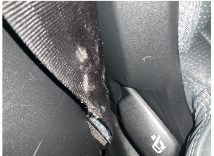
2.1 Skade på belte (Utbedres)
