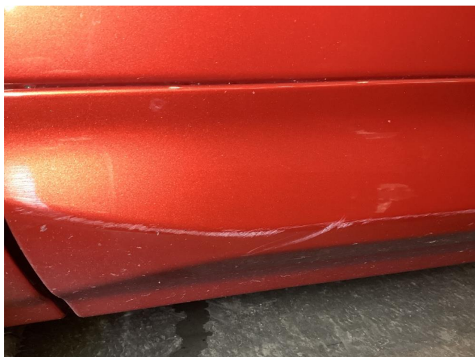
1.1 Ripe ned til grunning (Reparert)
