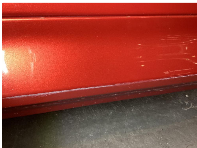
1.1 Ripe ned til grunning (Reparert)
