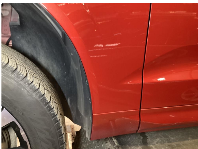
1.2 Ripe(r) ned til grunning (Reparert)
