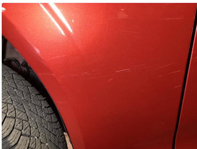
1.2 Ripe(r) ned til grunning (Reparert)
