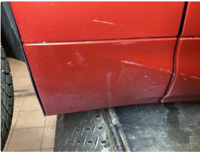
1.2 Ripe(r) ned til grunning (Reparert)
