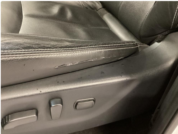
4.2 Sprukket ytterlag på skinn, side av førerstol.
