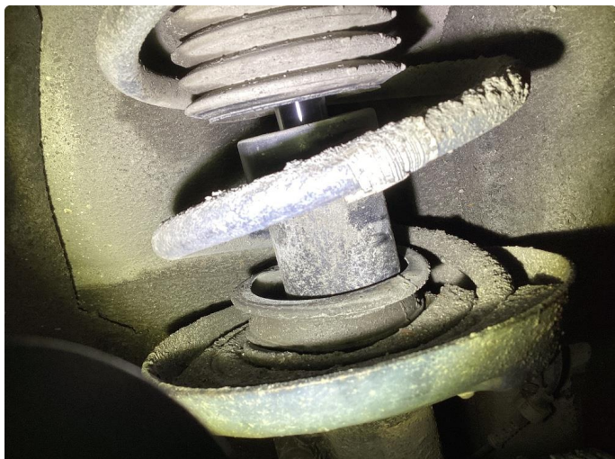
2.1 Støvmansjett defekt, begge foran. Dempere er ok.
