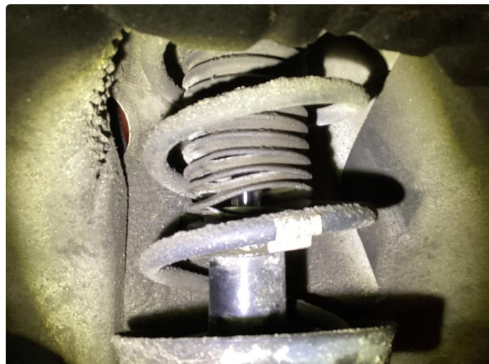
2.1 Støvmansjett defekt, begge foran. Dempere er ok.
