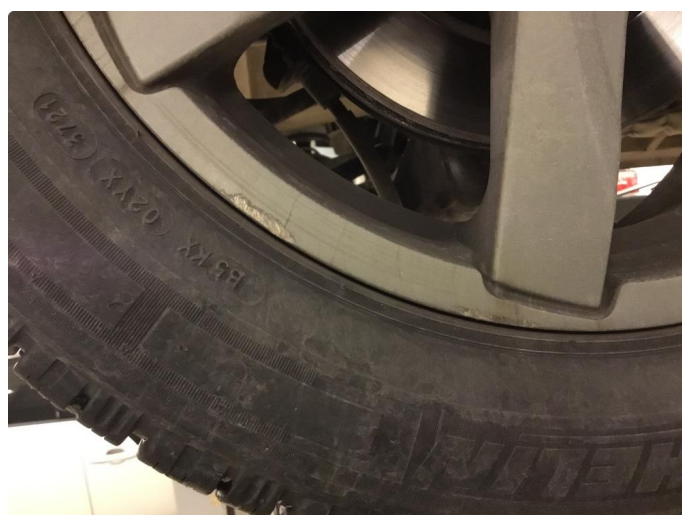
1.6 Endel små skader på alle felger.
