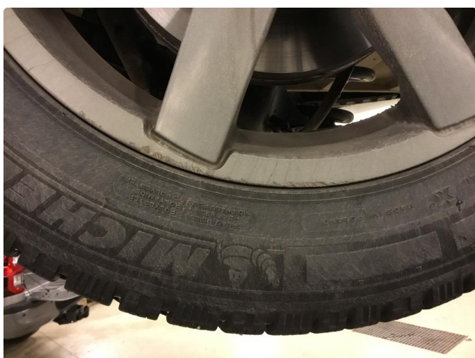
1.6 Endel små skader på alle felger.
