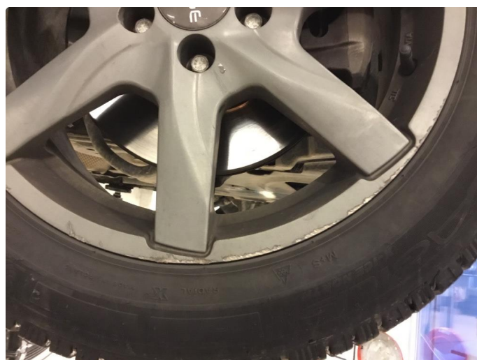
1.6 Endel små skader på alle felger.
